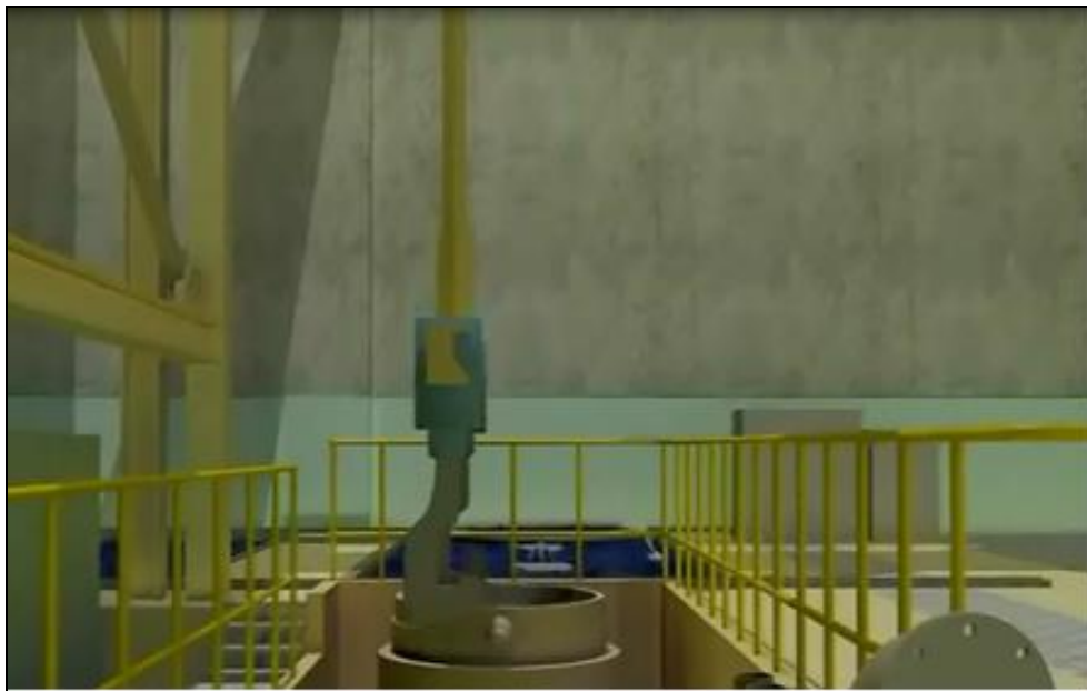
Figura 4-24 - Preparação para imersão no Cask Pool.
