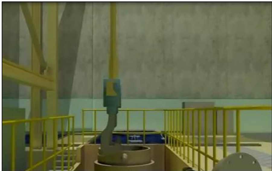
Figura 2-4 – Preparação para imersão no Cask Pool
