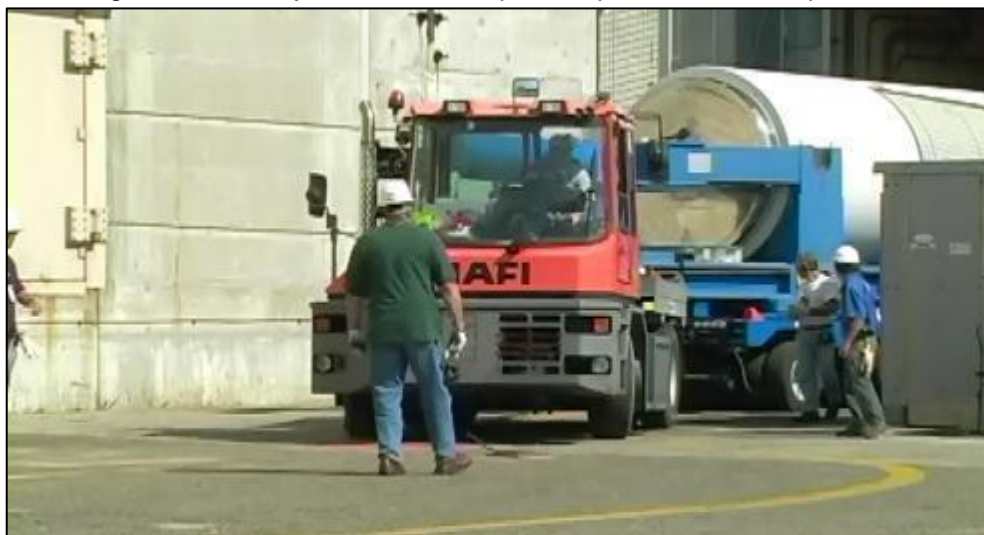
Figura 2-12 - Conjunto sendo transportado por Veículo Transportador
