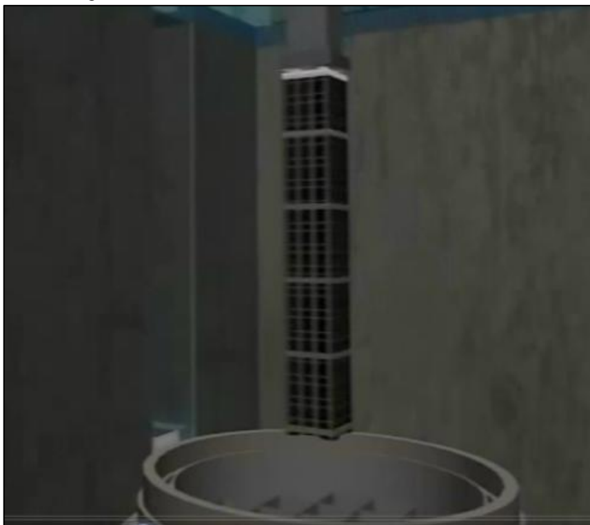
Figura 2-6 - ECI sendo colocado no interior do Canister.
