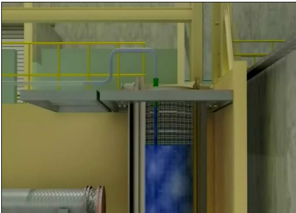
Figura 4-58 - Sistema de secagem - Drenagem, secagem e selagem do Canister.
