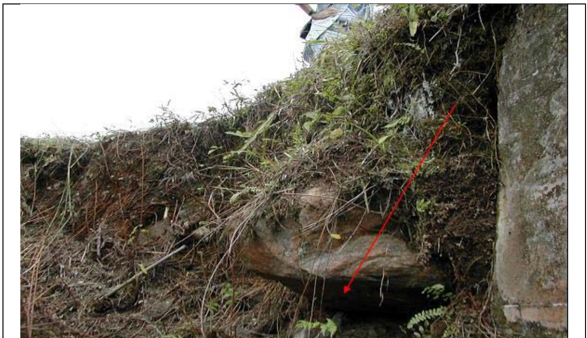
Figura 116 – Foto da erosão nos blocos de rocha do ponto 22 da folha 1. Fonte: “Levantamento e Diagnóstico Ambiental (Meio Físico) da Área de Influência da CNAAA – Vol II (Eixo 2 – Geologia e Recursos Hídricos)”, IGEO/UFRJ.
