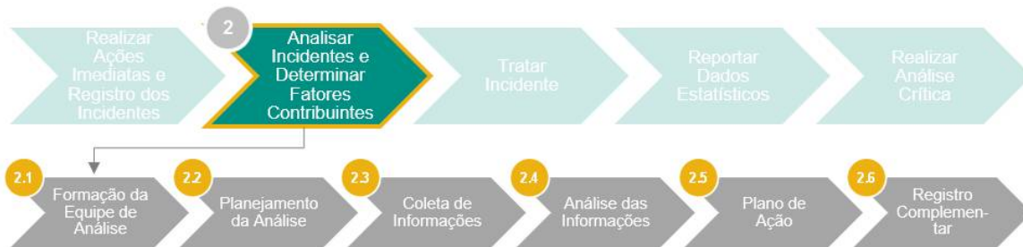
Figura 7: Etapas de análise de um incidente. Fonte: PGS-003384, Rev.: 09 - 30/06/2020, Gerenciamento de Incidentes de Saúde, Segurança, Meio Ambiente e Comunidade.
