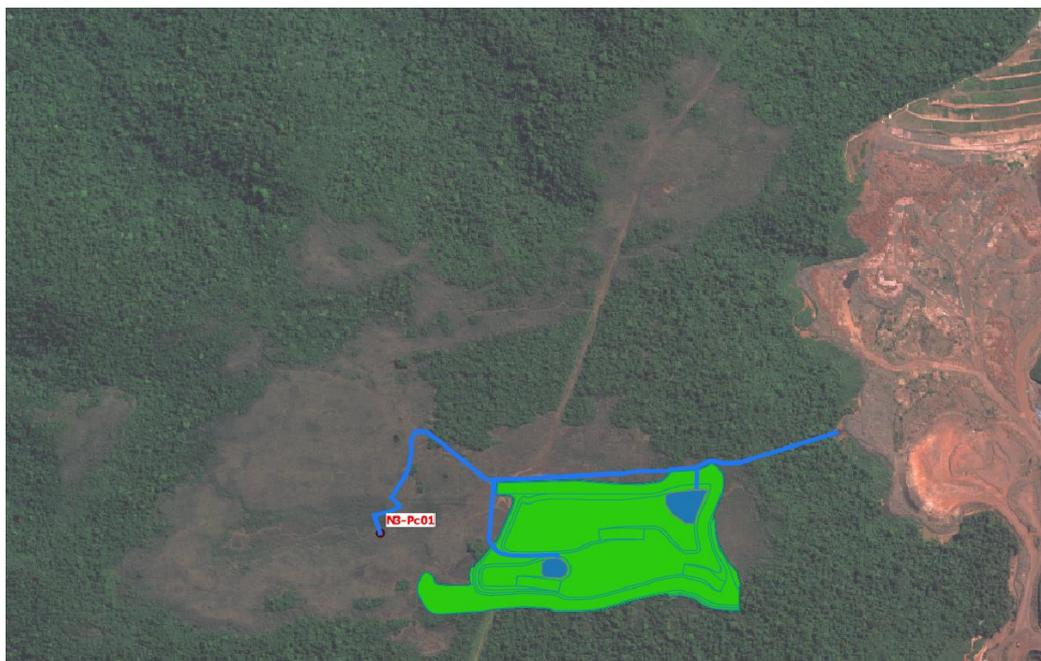
Figura 3-40: Ano 01: Deverá ser perfurado o primeiro poço já no primeiro ano de operação. Serão construídos 2 sumps, para armazenamento de água de chuva e a adutora em direção ao depósito Noroeste II.
