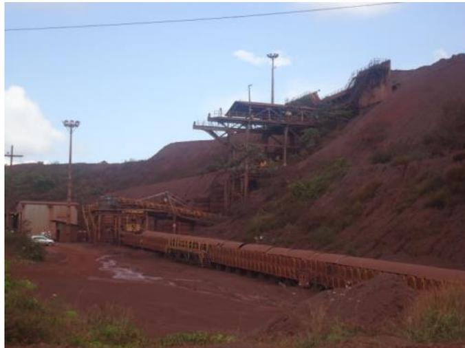
Foto 3-15: Britagem semimóvel III em operação no Complexo Minerador
