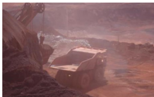
Carregamento de caminhão por escavadeira a cabo
