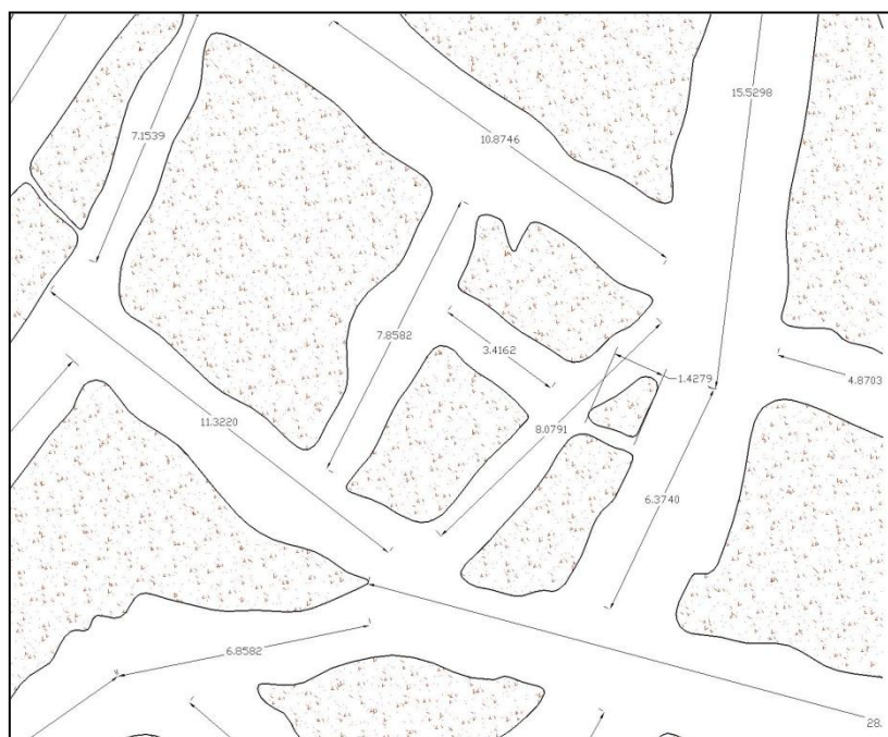
Figura 2.1. Medição da projeção horizontal de acordo com o método da descontinuidade.
