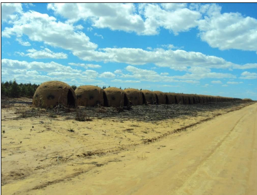
Foto 66 - Talhão de eucalipto no bloco M2 com os fornos utilizados para a produção do carvão vegetal.
