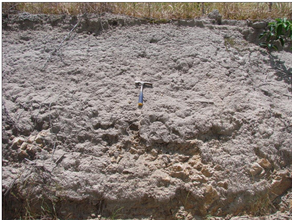
Foto 10.38 - Perfil de Chernossolo Argilúvico com horizonte A sobre Bi, com a rocha alterada aparente.
