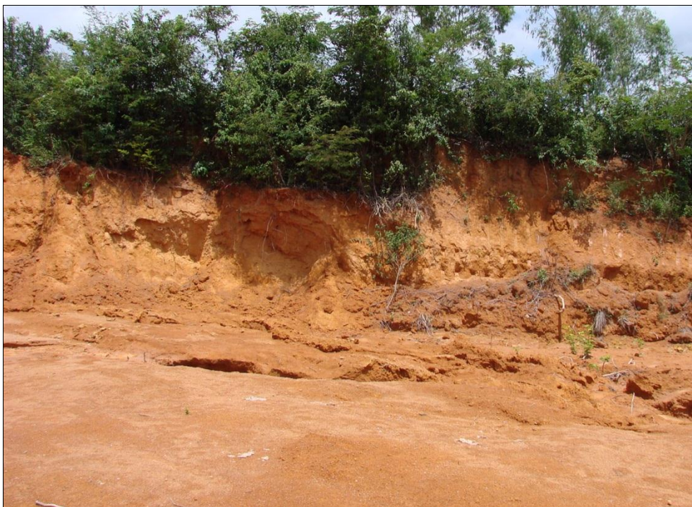
Foto 10.16 - Perfil de Latossolo Vermelho-Amarelo nas proximidades do Mineroduto, após o povoado de Barreiro (201.538/8.262.835 - 24L). Este perfil tem aproximadamente 3 metros de altura, com desenvolvimento do horizonte B bem evidenciado, bem como com horizonte A incipiente, com cerca de 20 cm e fase pedregosa.
