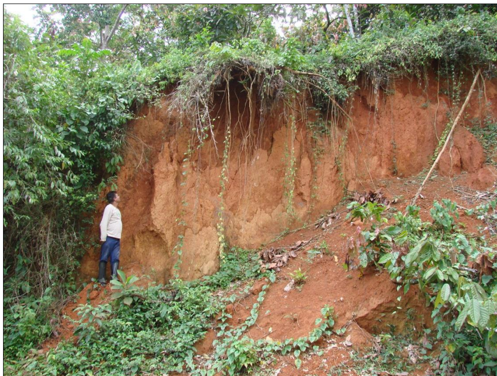
Foto 10.44 - Argissolo Vermelho-Amarelo encontrado em talude de estrada de terra no vale do rio Sete Voltas, município de Ilhéus (BA). O perfil do solo encontra-se bastante desenvolvido e homogêneo, com marcas de escorregamento devido à declividade do terreno e à maior permeabilidade da porção superior do perfil em relação à inferior, que apresenta acúmulo de argila.
