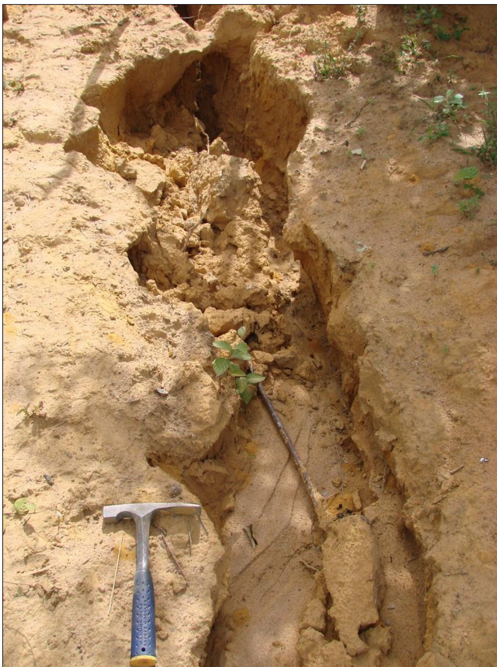
Foto 10.62 - Sulco em estrada vicinal, no município de Encruzilhada (BA), já no vale do rio Pardo - 293.258/8.292.085 - 24L.
