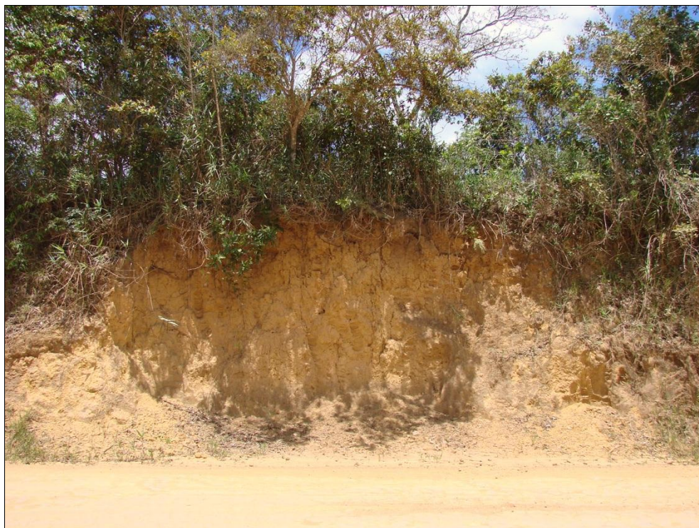
Foto 10.26 - Perfil de Latossolo Vermelho-Amarelo com cerca de 3,5 m de altura nas imediações do Mineroduto (307.355/8.299.058 - 24L). Observar horizonte A incipiente recoberto por vegetação esparsa.
