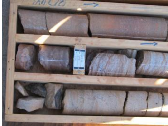
Figura 38: Testemunho do Bloco 7 com fraturas preenchidas indicando percolação de água
