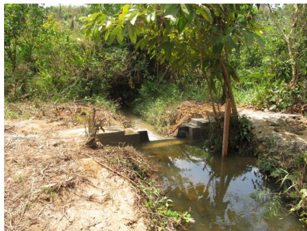
Figura 2: Vertedouro de Parede Delgada (Chapa Trapezoidal).
