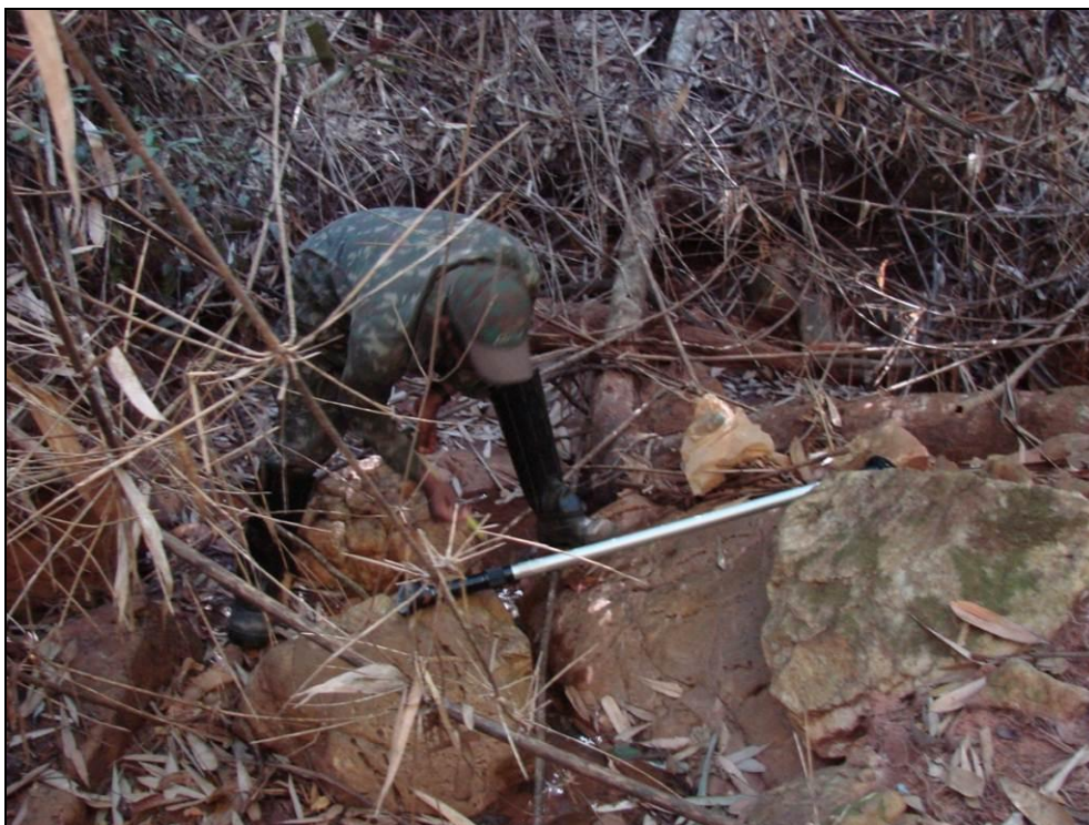
Foto 12.26 - Ponto no qual foi medida a vazão na cabeceira do córrego do Vale, correspondente a um segmento estreito e cheio de blocos no leito do canal.
