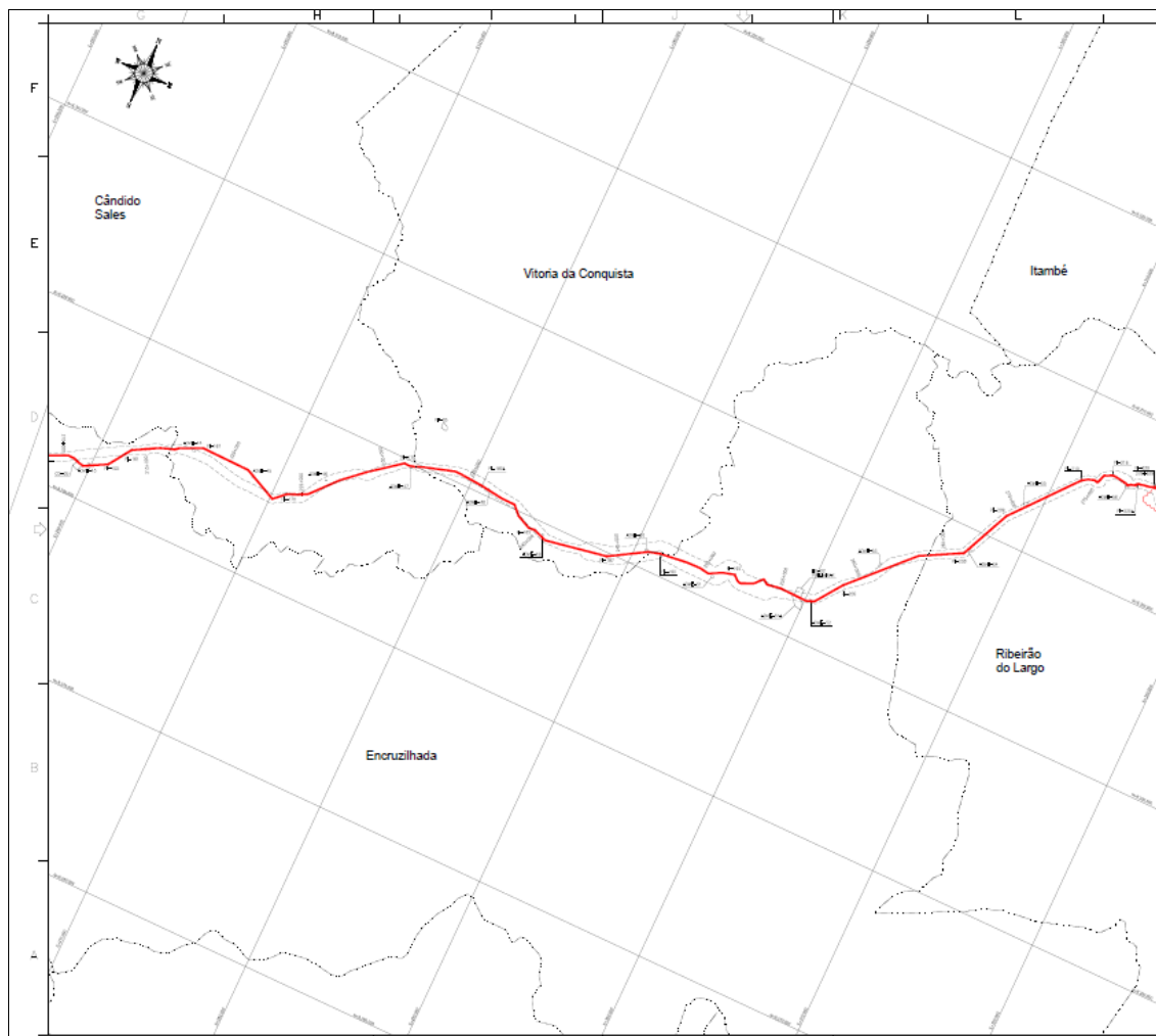
FIGURA 6.25 - Traçado e instalações do mineroduto - Trecho 4
