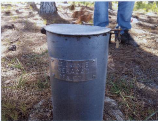
Figura 19. Detalhe do piezômetro nº 05 da RGM instalado na área de plantio de Pinus da FLOPAL.
