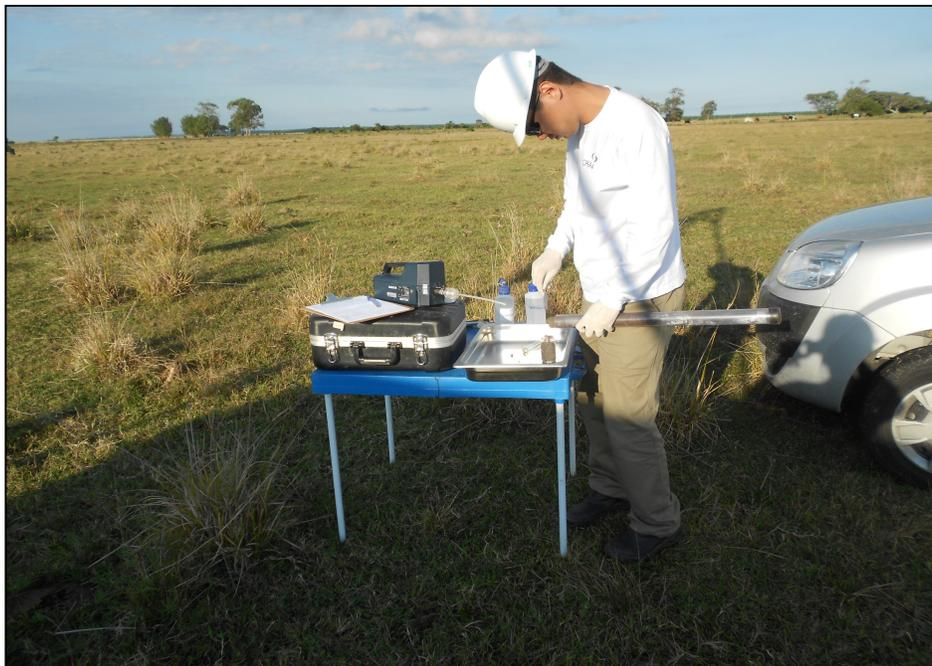
Figura 4 - Amostragem de solo coletadas com liner.
