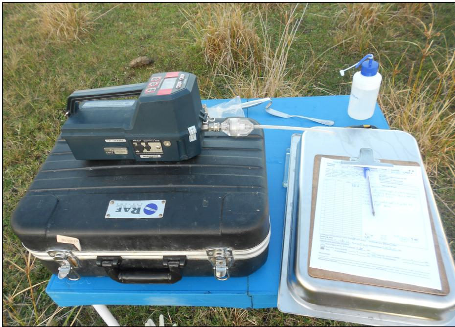
Figura 5 - Equipamento de medição de gases nas amostras de solo.
