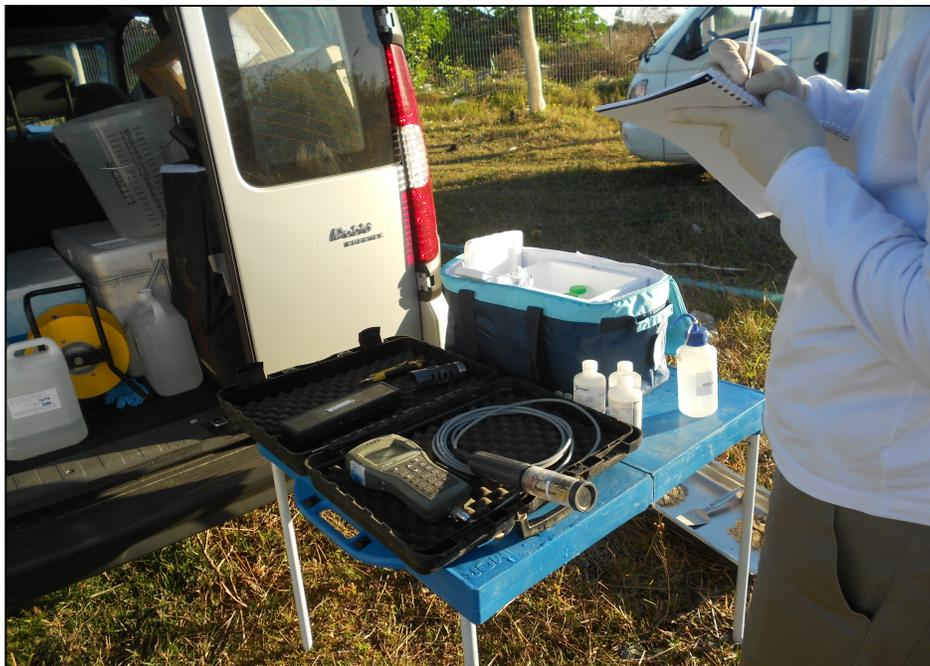
Figura 6 - Equipamento de medição multiparâmetros.
