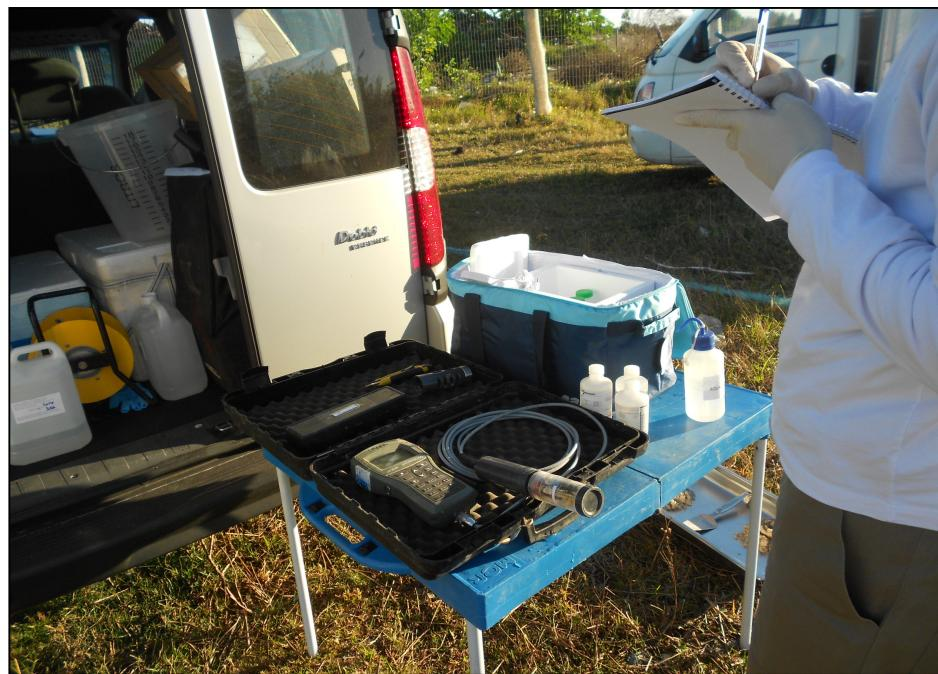
Figura 6 - Equipamento de medição multiparâmetros.
