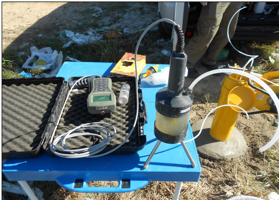
Figura 8 - Estação de amostragem em baixa vazão.
