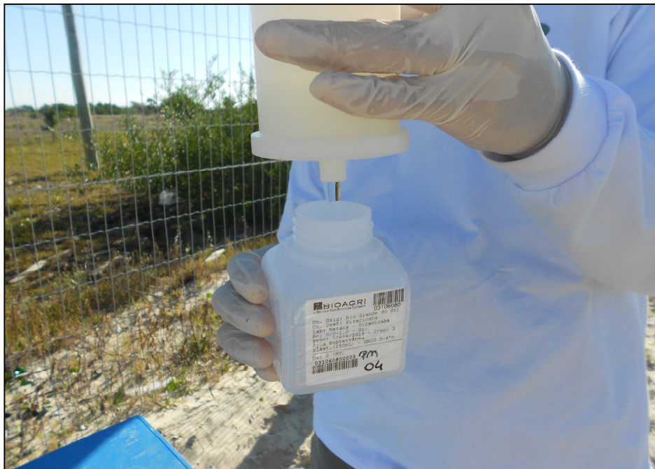
Figura 10 - Filtragem das amostras em campo para análise de metais dissolvidos.
