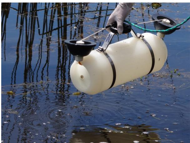
Figura 5. Lançamento da garrafa do tipo *van Dorn* para a amostragem de água.
