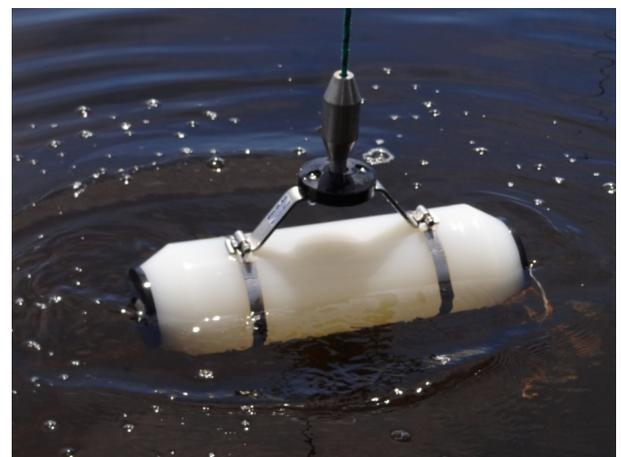
Figura 6. Amostra de água coletada com a garrafa do tipo *van Dorn*.
