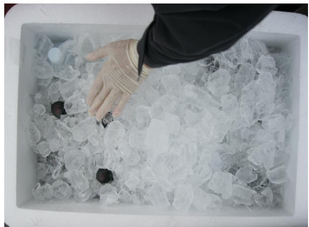
Figura 12. Preservação das amostras em caixas térmicas com gelo.
