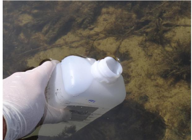
Figura 8. Coleta de água superficial através da imersão direta dos frascos sem preservante no corpo hídrico.
