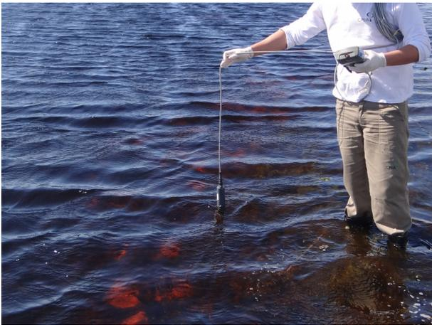
Figura 3. Medição dos parâmetros físico-químicos *in situ* utilizando a sonda multiparamétrica da marca HANNA modelo HI 9828.
