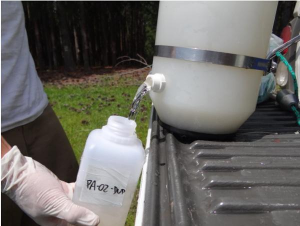
Figura 7. Acondicionamento das amostras de água superficial em frascos apropriados, fornecido pelo laboratório responsável pelas análises.
