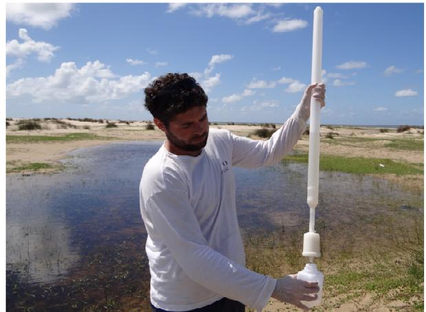
Figura 10. Filtração da amostra realizada *in situ* para análise de metais dissolvidos.
