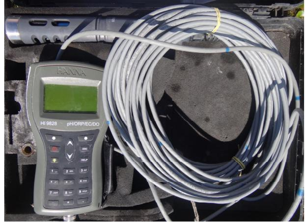
Figura 2. Sonda multiparamétrica da marca HANNA modelo HI 9828 utilizada para as medições físico-químicas *in situ*.
