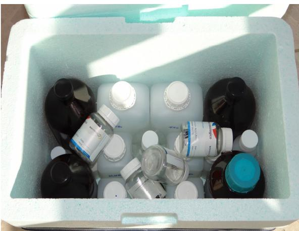
Figura 11. Frascaria fornecida pelo laboratório para amostragem de água superficial.
