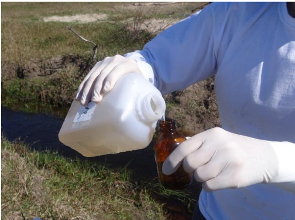
Figura 9. Transferência da água superficial para frascaria contendo preservantes, fornecida pelo laboratório responsável pelas análises.
