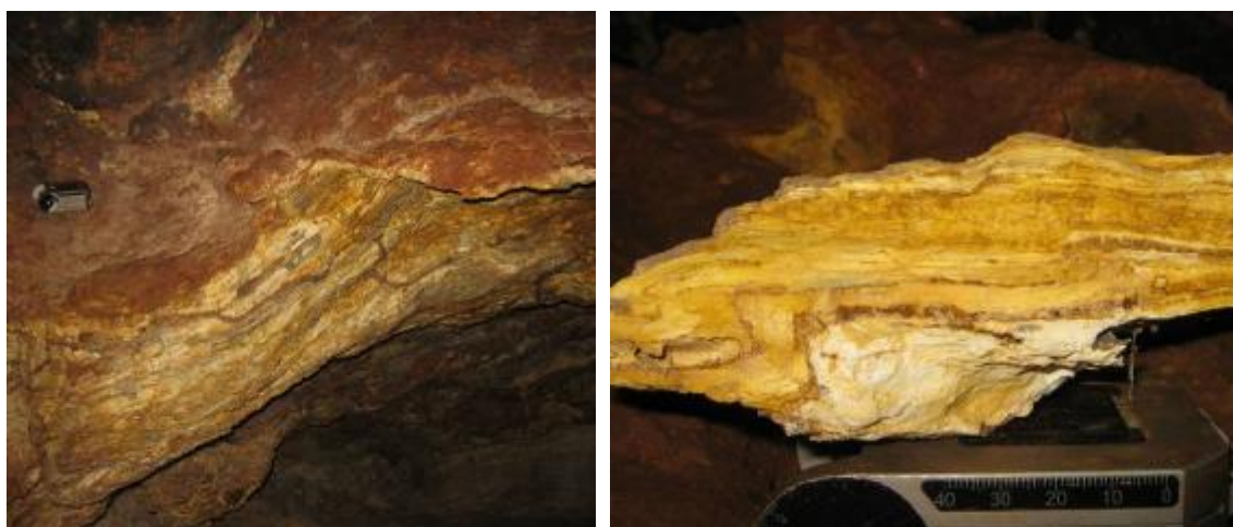
Figura 35. Jaspilito alterado na caverna S11-02; à esquerda é possível observar o mergulho da rocha (a bússola está na posição horizontal) e a camada delgada de óxido de ferro na superfície; à direita, camadas saprolíticas (amarelas e brancas) intercaladas a camadas mais ferruginosas.
