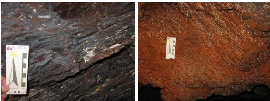
Figura 30. Minério de ferro pouco alterado e alterado, nas cavernas S11D-67 e S11D-60, respectivamente.
