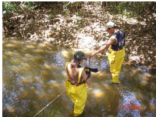
FOTO 04 – Procedimento de medição de vazão- período estiagem.
