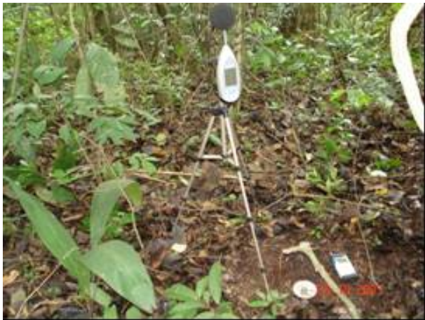
FOTO 6.1.4.6 – Fotos do posicionamento do microfone e acelerômetro no ponto de medição P6.
