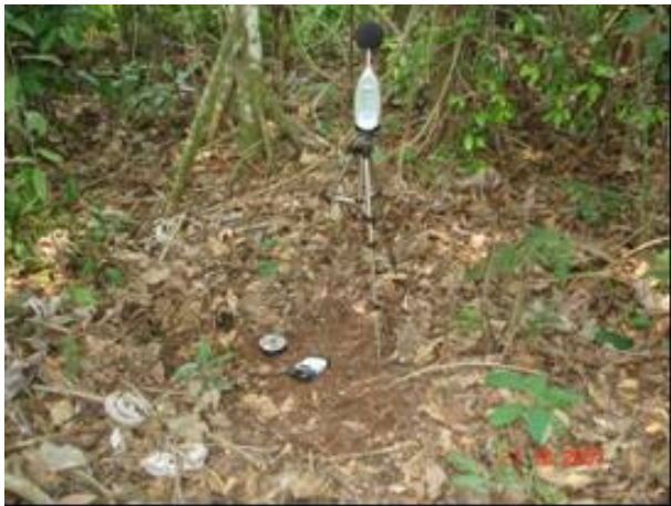
FOTO 6.1.4.9 – Fotos do posicionamento do microfone e acelerômetro no ponto de medição P9.
