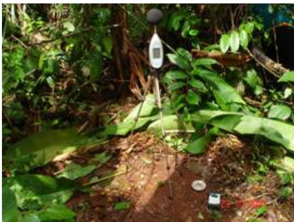
FOTO 6.1.4.19 – Fotos do posicionamento do microfone e acelerômetro no ponto de medição P19.
