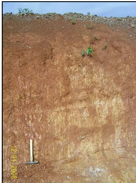
FOTO 6.1.5.11 – Saprolito de Gnaisse Xingu, com foliação bastante evidenciada pelo bandamento subvertical com cores contrastantes (E=582.044/N=9.282.314).
