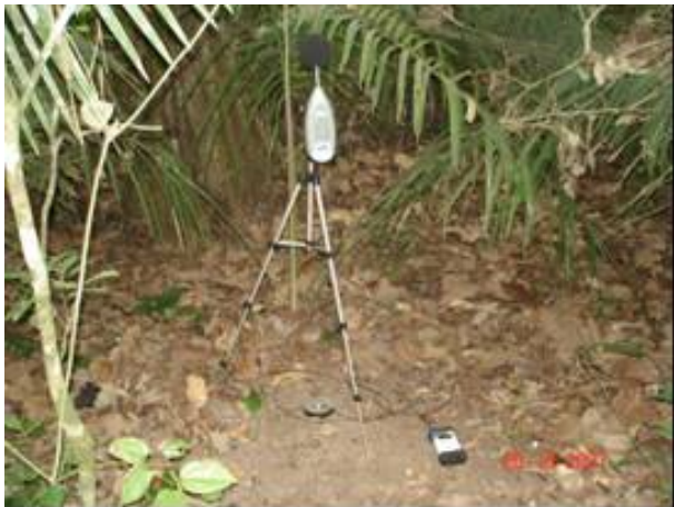
FOTO 6.1.4.7 – Fotos do posicionamento do microfone e acelerômetro no ponto de medição P7.
