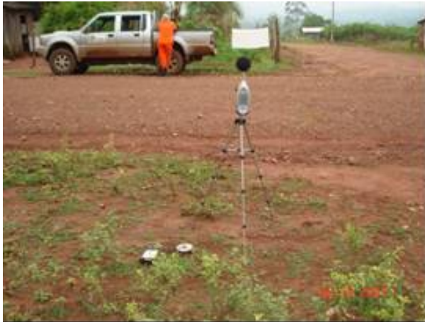
FOTO 6.1.4.11 – Fotos do posicionamento do microfone e acelerômetro no ponto de medição P11.
