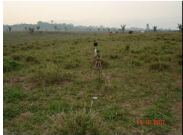
FOTO 6.1.4.14 – Fotos do posicionamento do microfone e acelerômetro no ponto de medição P14.
