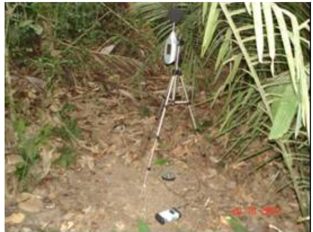
FOTO 6.1.4.7 – Fotos do posicionamento do microfone e acelerômetro no ponto de medição P7.
