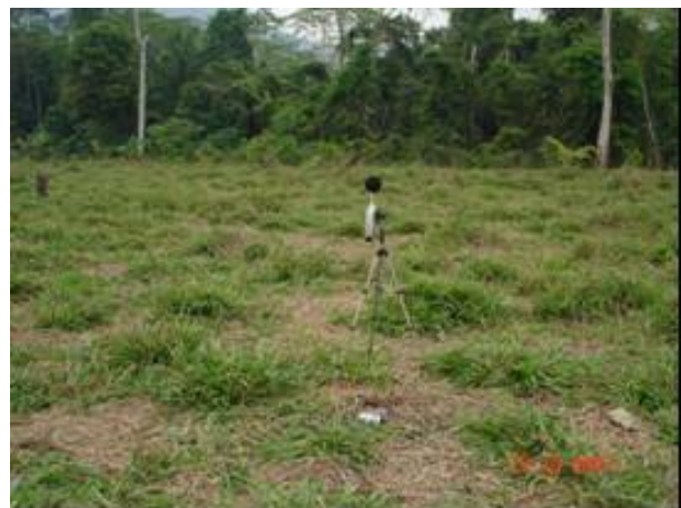
FOTO 6.1.4.16 – Fotos do posicionamento do microfone e acelerômetro no ponto de medição P16.
