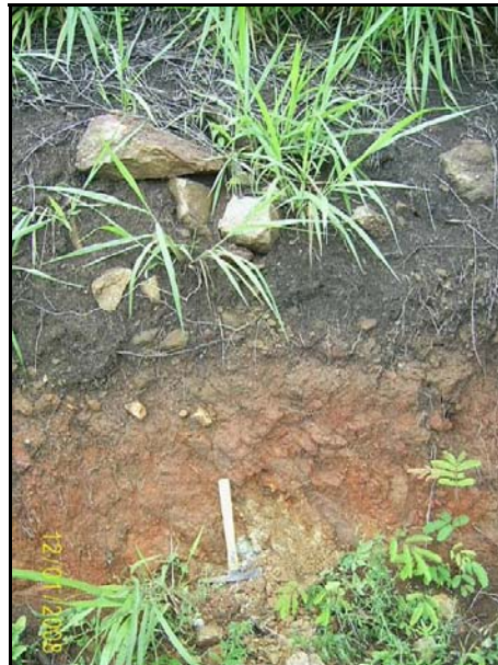
FOTO 6.1.5.44 – Colúvio de solo argilo-arenoso com fase pedregosa sobre saprolito de granito Plaquê (E=581.269/N=9.280.116)
