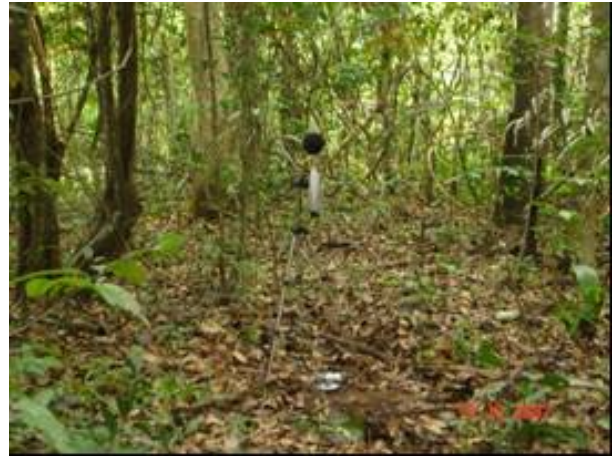
FOTO 6.1.4.5 – Fotos do posicionamento do microfone e acelerômetro no ponto de medição P5.
