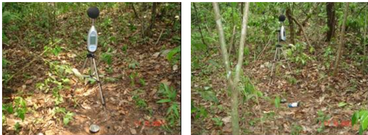
FOTO 6.1.4.20 – Fotos do posicionamento do microfone e acelerômetro no ponto de medição P20.
