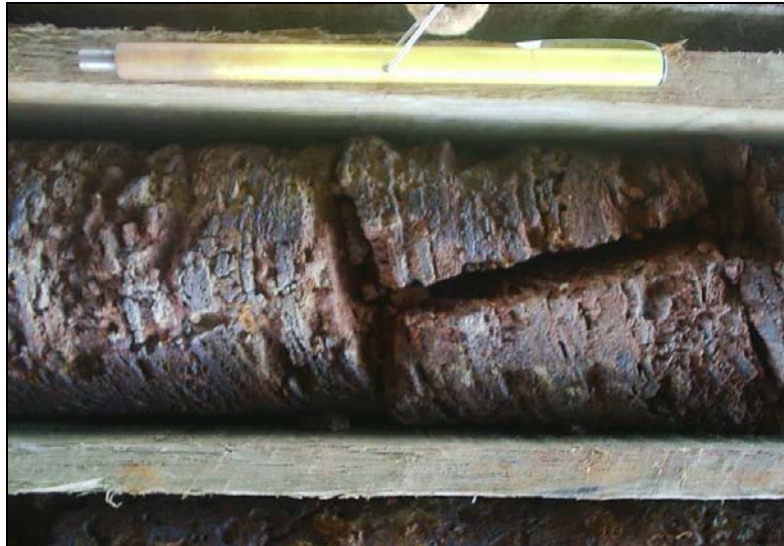
FOTO 6.1.5.6 – Aspecto de testemunho de sondagem rotativa em camada de hematita laminada lateritizada
