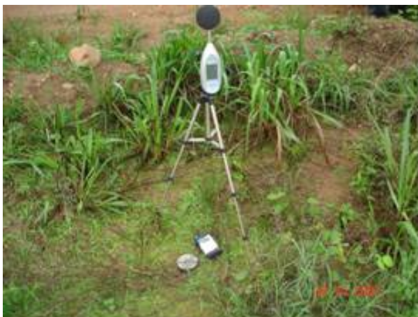
FOTO 6.1.4.13 – Fotos do posicionamento do microfone e acelerômetro no ponto de medição P13.
