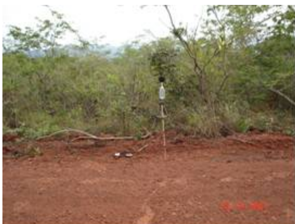
FOTO 6.1.4.4 – Fotos do posicionamento do microfone e acelerômetro no ponto de medição P4.
