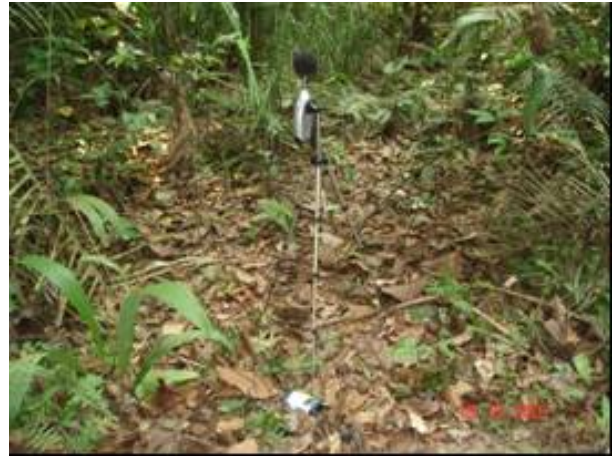
FOTO 6.1.4.8– Fotos do posicionamento do microfone e acelerômetro no ponto de medição P8.
