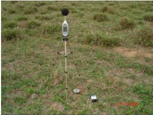
FOTO 6.1.4.14 – Fotos do posicionamento do microfone e acelerômetro no ponto de medição P14.
