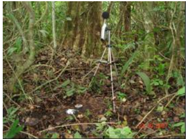
FOTO 6.1.4.6 – Fotos do posicionamento do microfone e acelerômetro no ponto de medição P6.
