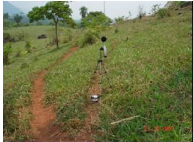
FOTO 6.1.4.17– Fotos do posicionamento do microfone e acelerômetro no ponto de medição P17.
