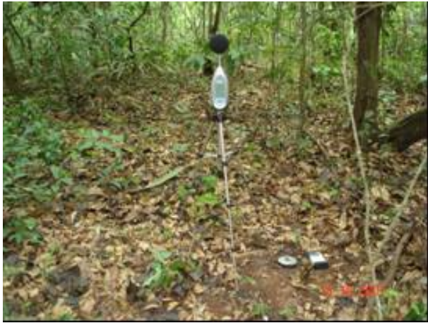
FOTO 6.1.4.5 – Fotos do posicionamento do microfone e acelerômetro no ponto de medição P5.
