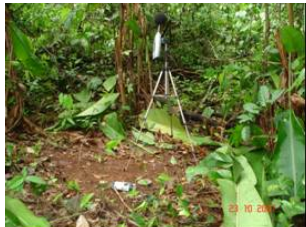
FOTO 6.1.4.19 – Fotos do posicionamento do microfone e acelerômetro no ponto de medição P19.
