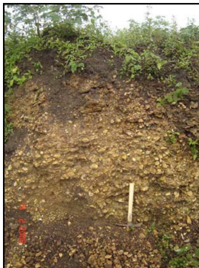
FOTO 6.1.5.8 – Depósito aluvionar de cascalho de seixo rolado quartzoso, capeado por horizonte de colúvio de cascalho granular laterítico (margem esquerda do rio Pacu, UTM E=587.003/N=9.288.206)
