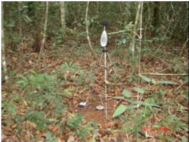
FOTO 6.1.4.10 – Fotos do posicionamento do microfone e acelerômetro no ponto de medição P10.
