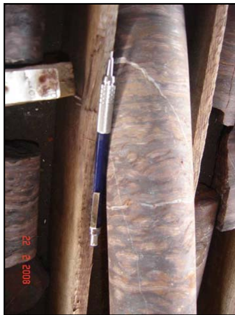
FOTO 6.1.5.32 – Testemunho de sondagem mostrando a foliação e bandamento da Formação Ferrífera
