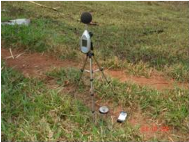
FOTO 6.1.4.17– Fotos do posicionamento do microfone e acelerômetro no ponto de medição P17.
