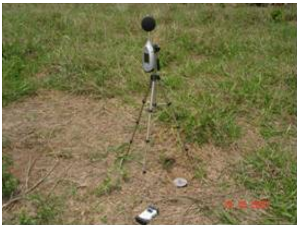
FOTO 6.1.4.15 – Fotos do posicionamento do microfone e acelerômetro no ponto de medição P15.
