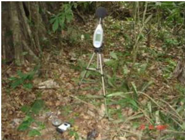
FOTO 6.1.4.18 – Fotos do posicionamento do microfone e acelerômetro no ponto de medição P18.
