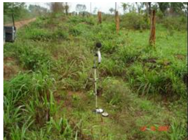
FOTO 6.1.4.13 – Fotos do posicionamento do microfone e acelerômetro no ponto de medição P13.
