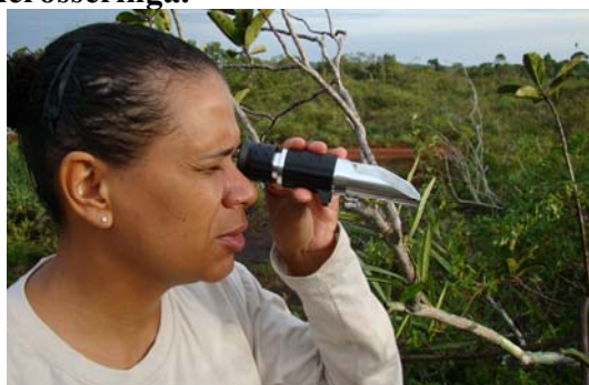
FOTO 1.3.2.20 - Procedimento de leitura da concentração de açúcar do néctar no refratômetro portátil.
