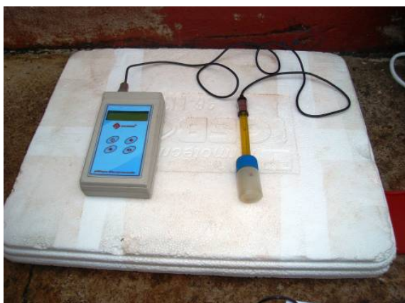
FOTO 1.3.1.1 – Equipamento portátil de medição de pH e Eh.
