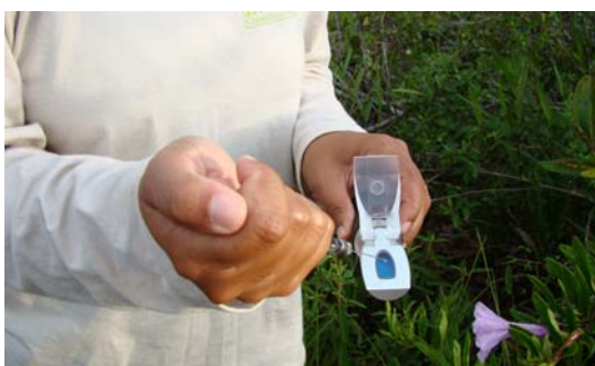
FOTO 1.3.2.19 - Procedimento de transferência do néctar para o refratômetro portátil para medição da concentração de açúcar.
