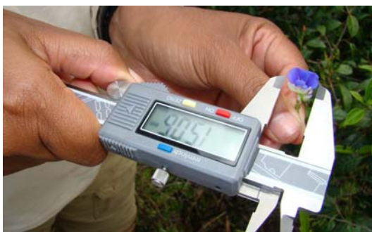
FOTO 1.3.2.21 - Procedimento de medição das dimensões de flor com uso de paquímetro digital.
