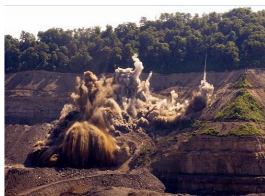
EXEMPLO DE FONTE DE VIBRAÇÃO: DESMONTE COM EXPLOSIVO DURANTE ATIVIDADE DE MINERAÇÃO
