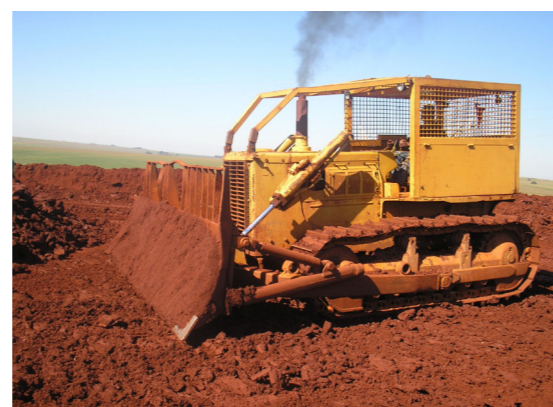
EXEMPLO DE MÁQUINA OPERANDO DESREGULADA QUEIMANDO COMBUSTÍVEL E EMITINDO GASES POLUENTES
