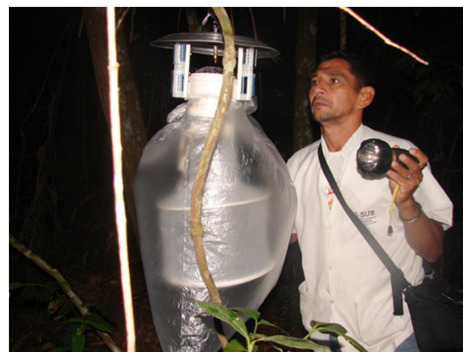
ARMADILHA LUMINOSA PARA COLETA DE MOSQUITOS
