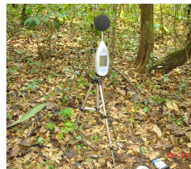
EQUIPAMENTOS UTILIZADOS PARA MEDIÇÃO DE RUÍDOS E VIBRAÇÕES
