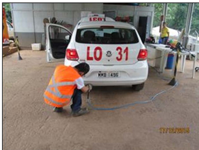
Figura 07 Procedimento de Medição de Opacidade
