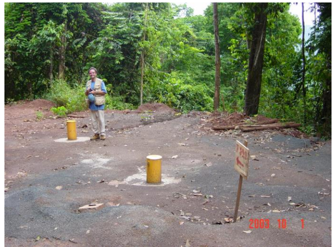
Piezômetro jorrante, na área da futura cava
