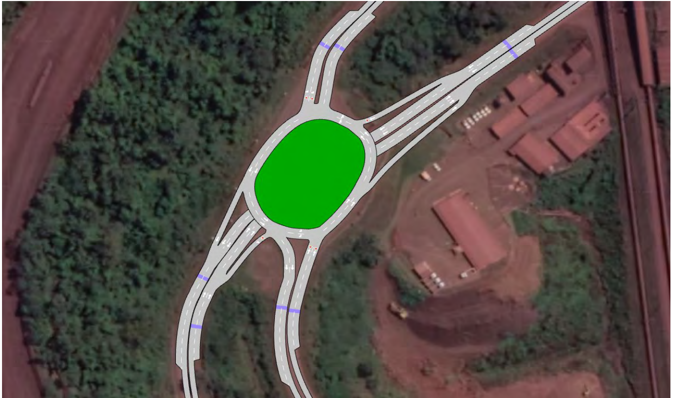
Figura 11.1: Rede de Simulação Intervenção Rotatória Desnível Fonte: Elaboração Própria.
