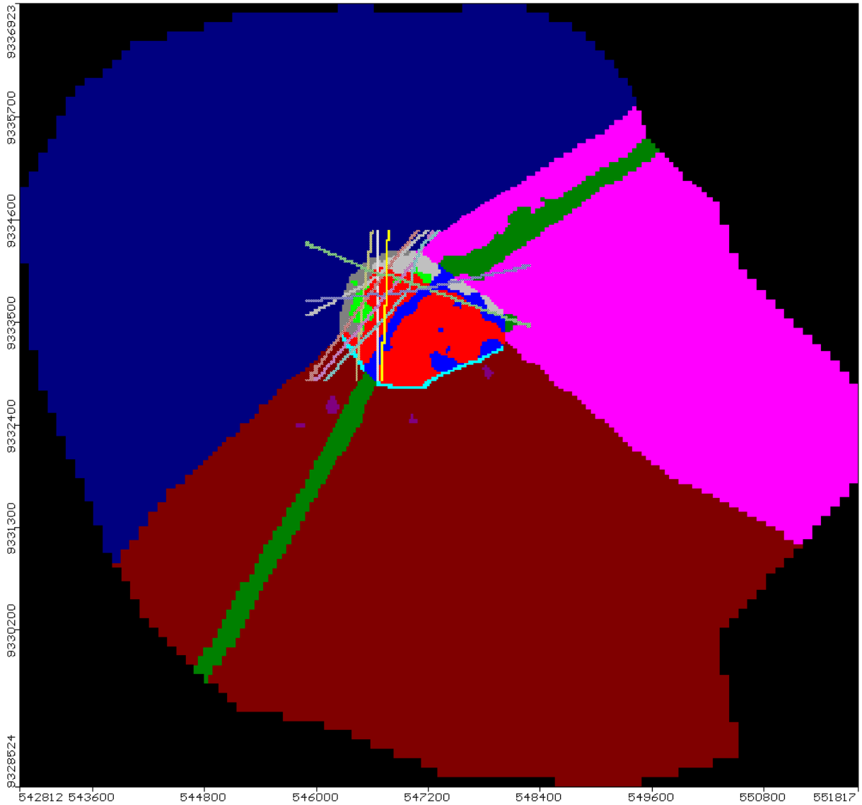
Figura 5.3: Distribuição da condutividade hidráulica na camada 11.
