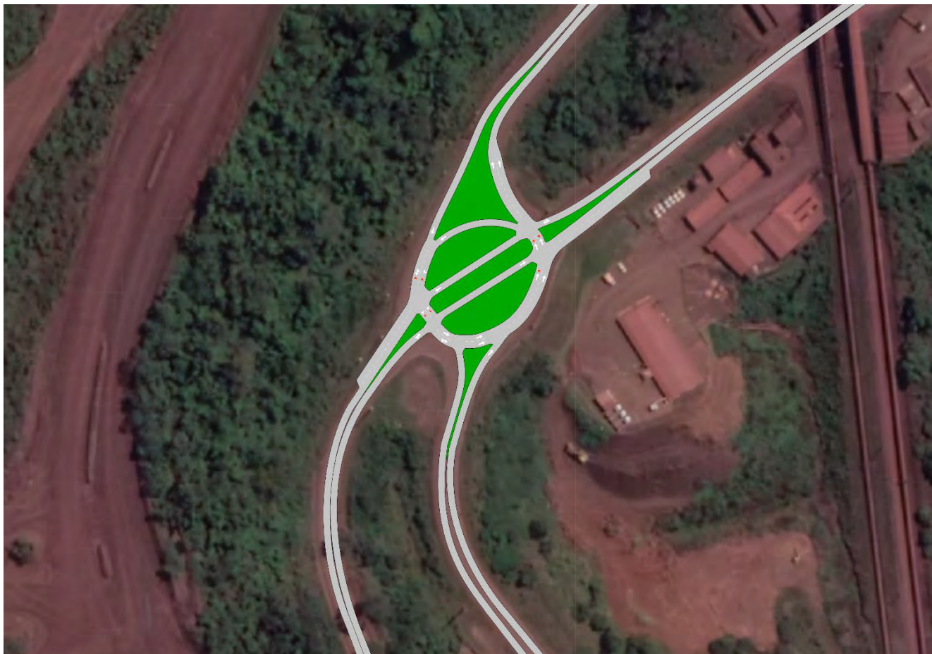
Figura 10.1: Rede de Simulação Intervenção Rotatória Fonte: Elaboração Própria.
