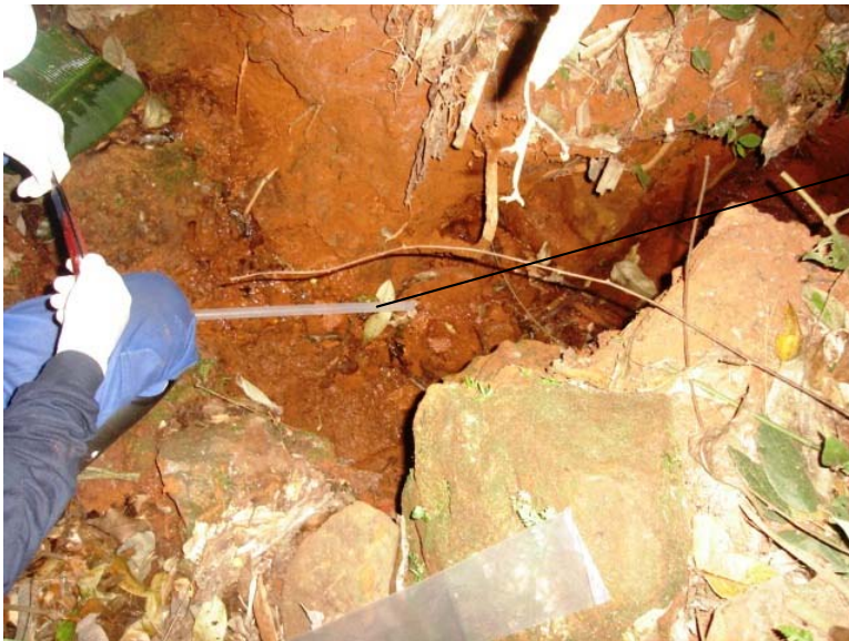
FOTO 02 – Pequeno vertedouro improvisado com bailer para realização da coleta.
