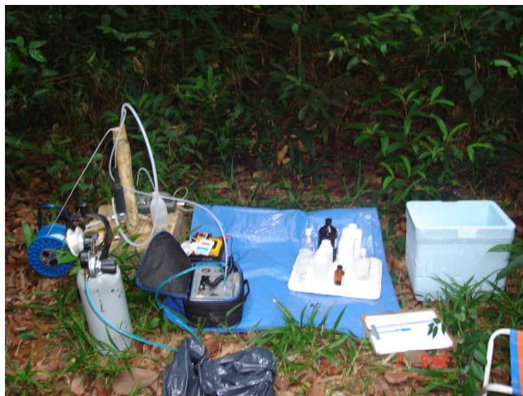
FOTO 05 - Procedimento de amostragem – método baixa vazão – campanha chuvosa.
