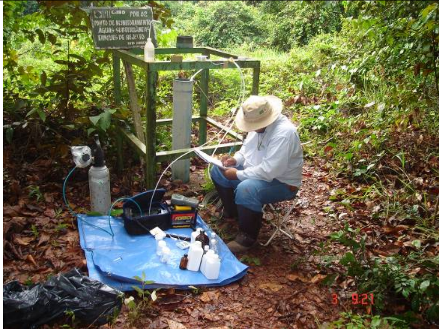
FOTO 07 – Procedimento de amostragem – método baixa vazão - campanha chuvosa.
