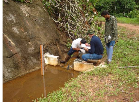
FOTO 03– Vista jusante com o vertedouro - campanha chuvosa.
