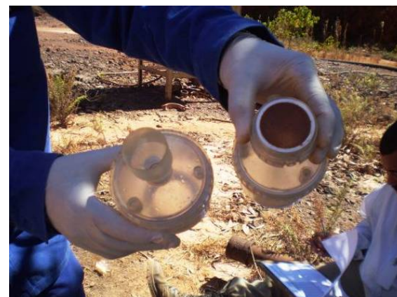
FOTO 07 – Presença de material particulado no filtro 0,45µ - campanha de estiagem.
