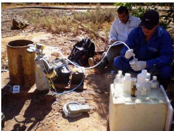
FOTO 04 – Procedimento de amostragem – método baixa vazão - campanha de estiagem.
