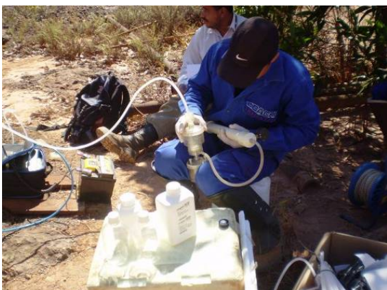
FOTO 06 – Filtração dos metais dissolvidos in loco - campanha de estiagem.
