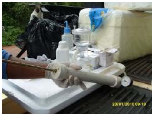
FOTO 06 – Filtração dos metais dissolvidos in loco
