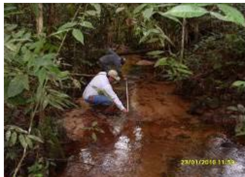
FOTO 04 – Procedimento de medição da velocidade de corrente
