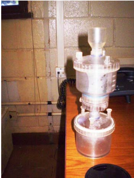
Foto 49 – Kitazato utilizado para filtração dos metais dissolvidos.
