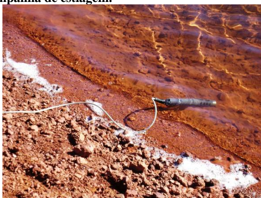
FOTO 05 – Medição dos parâmetros em campo com a sonda multiparâmetros.
