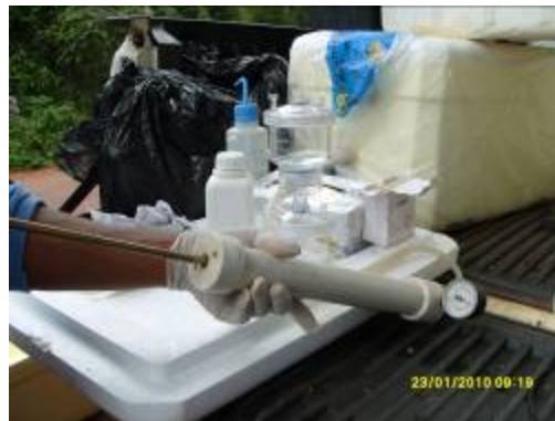
FOTO 06 – Filtração dos metais dissolvidos in loco
