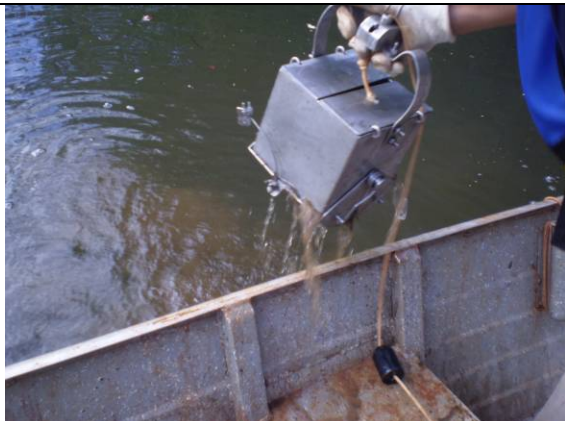
FOTO 05 – Coleta de sedimento com draga Eckmann para análise de zoobenton - campanha chuvosa.
