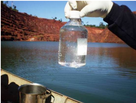
FOTO 07 –Aspecto visual da amostra AB01-C – Fundo do reservatório - campanha de estiagem.
