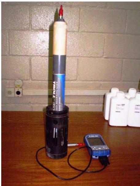
Foto 55 - Sonda para perfil térmico e de oxigênio dissolvido, multiparâmetros, modelo Trool 9500, marca in situ .
