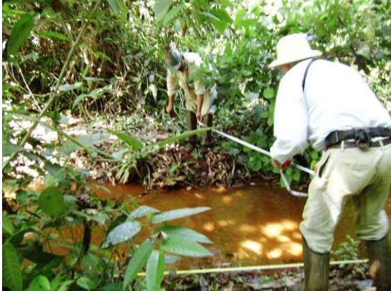
FOTO 05 – Procedimento de medição de vazão – campanha de estiagem.
