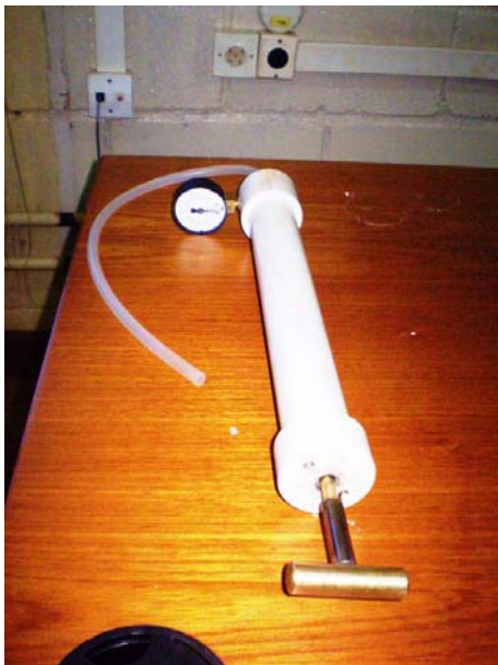
Foto 51 - Bomba a vácuo utilizada para filtração dos metais dissolvidos e da clorofila a
