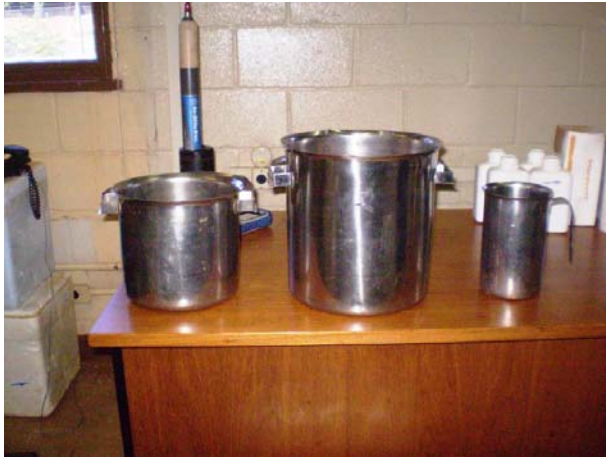
Foto 57 - Baldes inox (15, 5 e 2 litros) utilizados nas coletas das amostras
