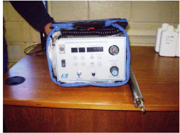
Foto 58 - Bomba pneumática controladora HS
