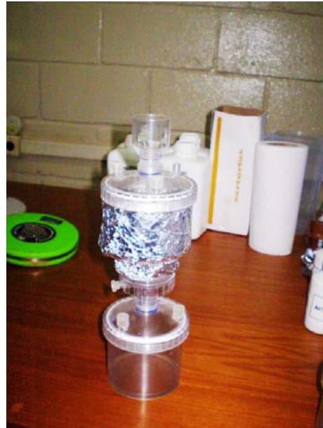
Foto 50 - Kitazato utilizado para filtração da clorofila a
