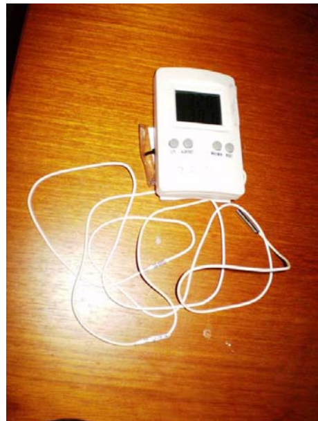
Foto 52 - Termômetro digital utilizado para medição da temperatura do ar.
