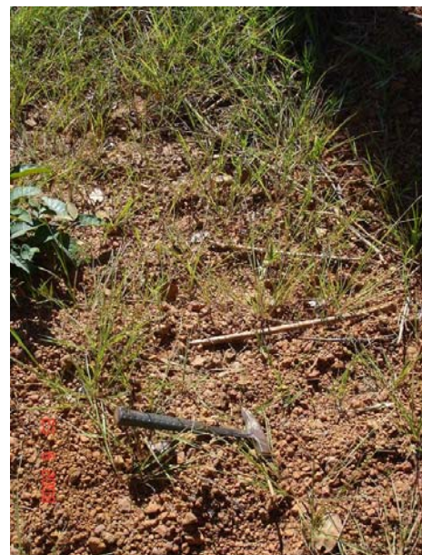
Foto 114 – A- 91 - Solo laterítico com fragmentos
