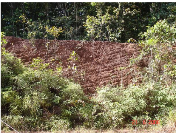
Foto 51 – A- 45 - Solo silto arenoso marrom avermelhado.
