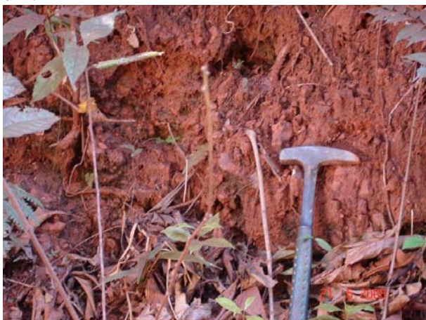
Foto 59 – A- 49 - Solo laterítico com fragmentos cm a dm.
