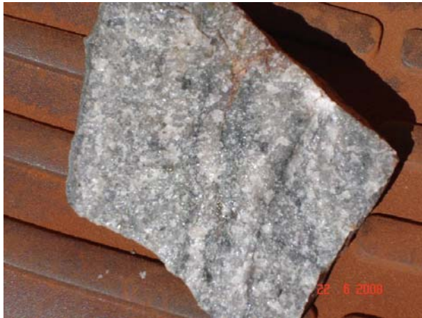
Foto 75 – A- 60 - Rocha extremamente resistente, recristalizada, com presença de sulfetos.
