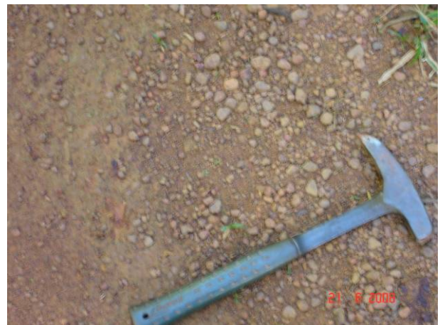
Foto 32 – A-30 - Solo silto argiloso com fragmentos lateríticos cm, subarredondados a subangulosos.
