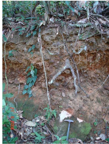
Foto 34 – A-32 - Blocos de arenito medianamente resistente de coloração branco acinzentada, sob solo coluvionar com fragmentos cm a dm lateríticos.
