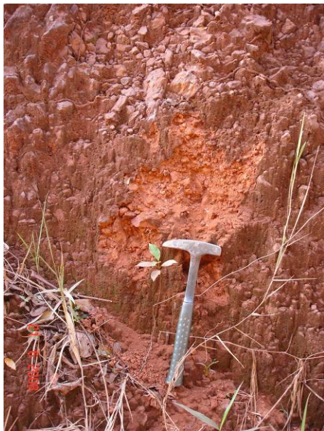
Foto 55– A- 47 - Talude à esquerda, de 4m de altura, de um solo laterítico com fragmentos cm.
