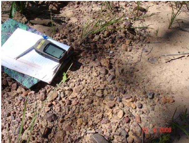
Foto 115 – A- 92 - Solo arenoso com fragmentos lateríticos.
