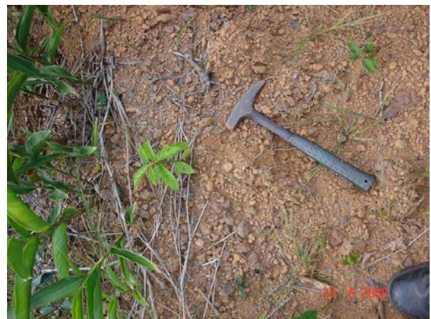
Foto 122– A- 96 - Solo laterítico marron avermelhado.
