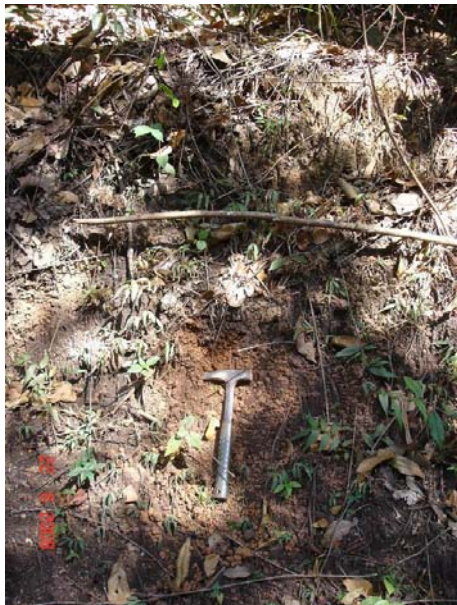
Foto 81 – A- 66 - Solo siltoso amarelado, com fragmentos.
