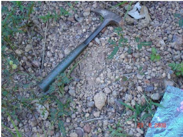
Foto 111 – A- 87 - Solo arenoso marrom claro, com muitos fragmentos lateríticos.
