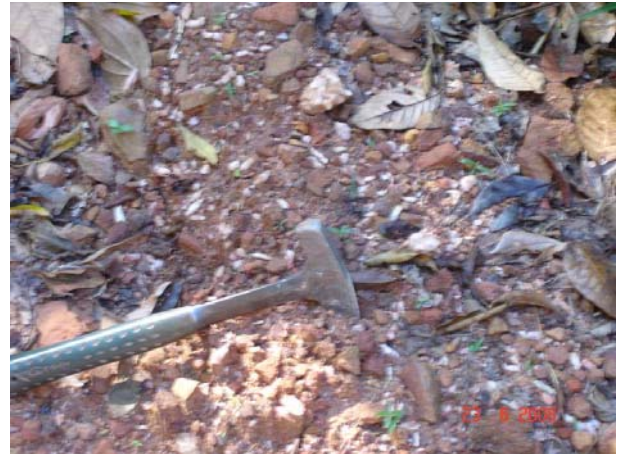
Foto 110 – A- 86 - Solo arenoso siltoso com fragmentos de quartzo de veio.
