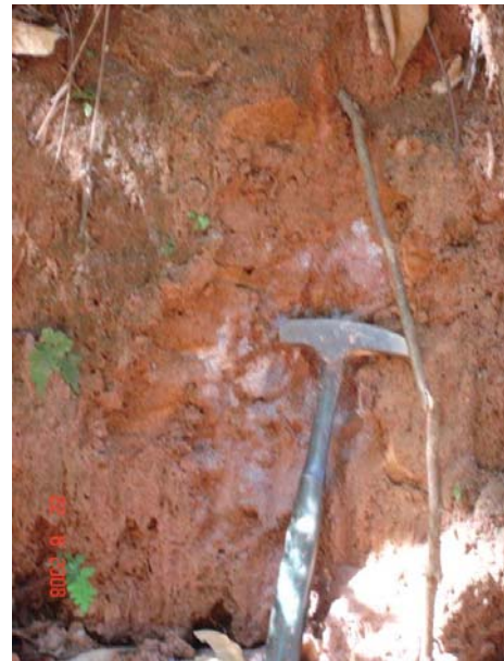
Foto 78 – A- 63 - 1m de solo laterítico sobre arenito totalmente friável.
