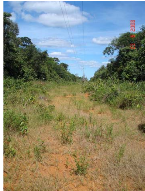
Foto 116 – A- 93 - Solo laterítico marron avermelhado.
