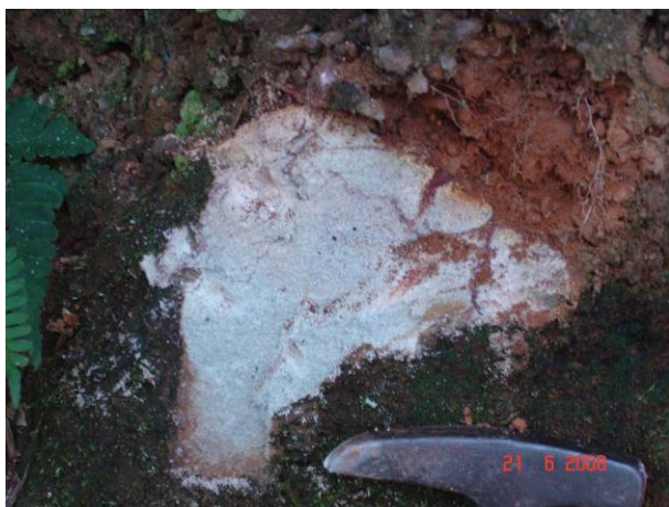
Foto 35 – A-32 - Blocos de arenito medianamente resistente de coloração branco acinzentada, sob solo coluvionar com fragmentos cm a dm lateríticos.
