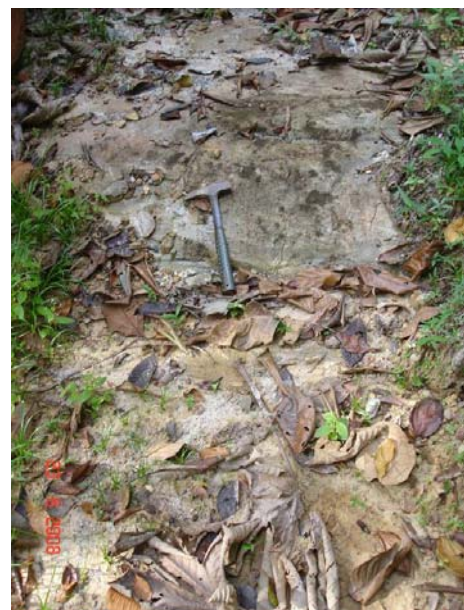
Foto 106 – A- 84 - Solo arenoso com blocos de arenito.
