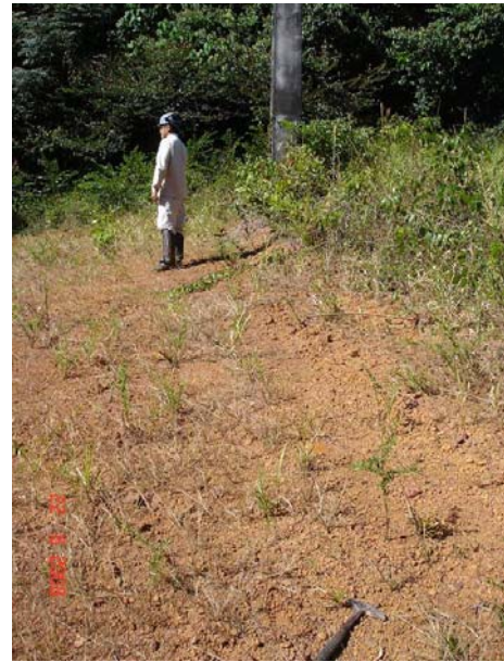
Foto 76 – A- 62 - Solo siltoso com fragmentos lateríticos.
