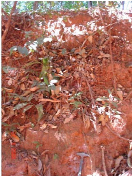
Foto 77 – A- 63 - 1m de solo laterítico sobre arenito totalmente friável.
