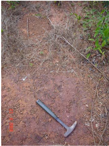
Foto 99 – A- 80 - Solo marrom avermelhado com fragmentos lateríticos e alguns blocos de canga.
