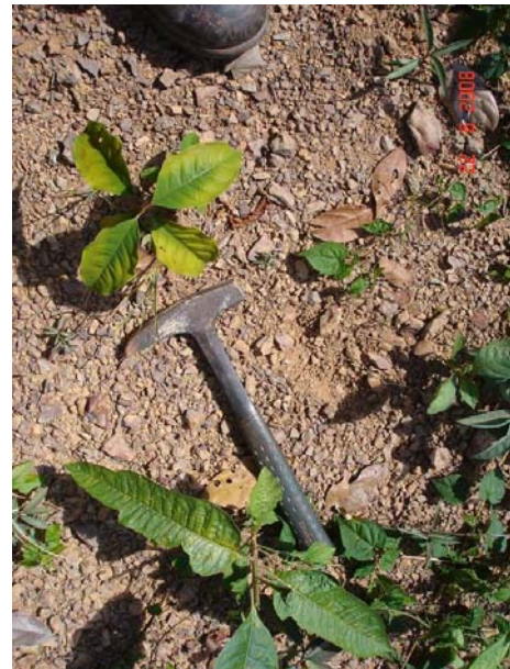
Foto 98 – A- 79- Solo silto arenoso amarelado com fragmentos lateríticos.
