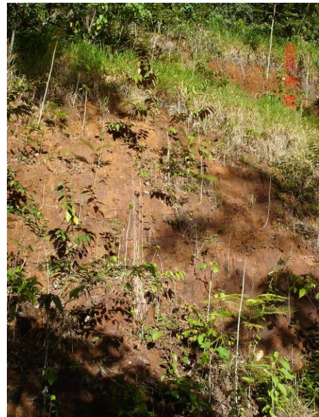
Foto 04 – A-02 - Arenito fino a médio, coloração bege rosada, medianamente resistente.
