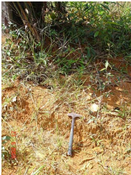
Foto 117 – A- 93 - Solo laterítico marron avermelhado.
