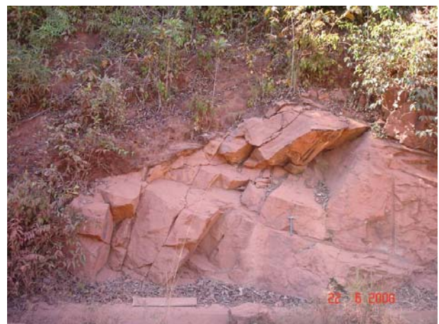
Foto 74 – A- 60 - Rocha extremamente resistente, recristalizada, com presença de sulfetos.
