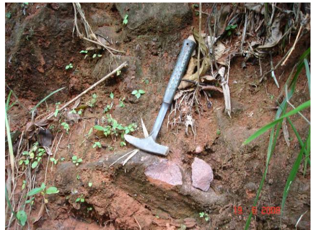
Foto 08 – A-05 - Arenito médio a grosso, rosado, friável a moderadamente friável, sotoposto a uma camada de 1m de um solo vermelho siltoso.
