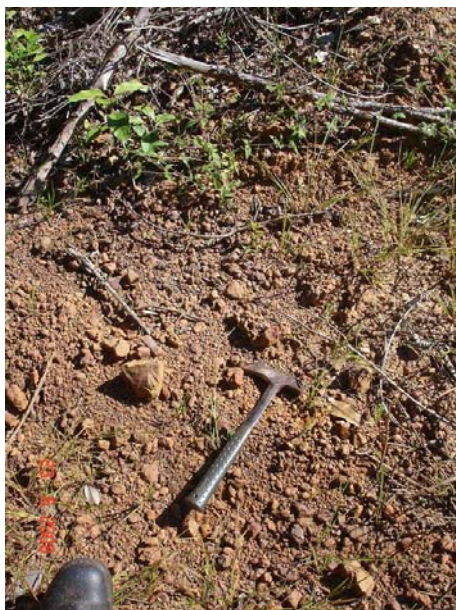
Foto 113 – A- 90 - Solo laterítico avermelhado, com fregmentos.
