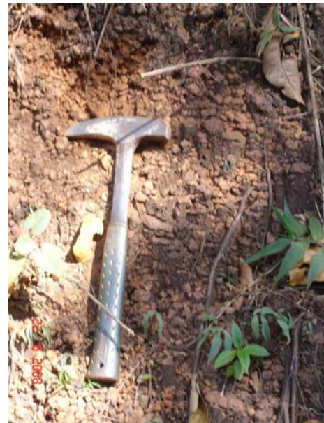
Foto 82 – A- 66 - Solo siltoso amarelado, com fragmentos.
