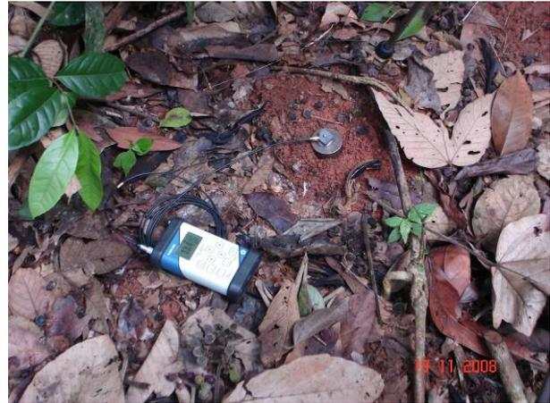
Figura A.7 – Local de medição com o microfone e o acelerômetro posicionados no ponto RVB-07
