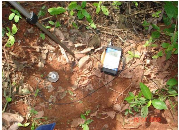
Figura A.2 – Local de medição com o microfone e o acelerômetro posicionados no ponto RVB-02
