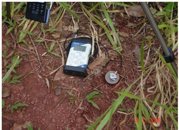
Figura A.3 – Local de medição com o microfone e o acelerômetro posicionados no ponto RVB-03
