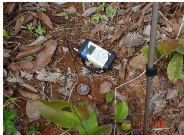
Figura A.5 – Local de medição com o microfone e o acelerômetro posicionados no ponto RVB-05
