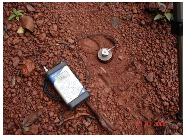
Figura A.9 – Local de medição com o microfone e o acelerômetro posicionados no ponto RVB-09
