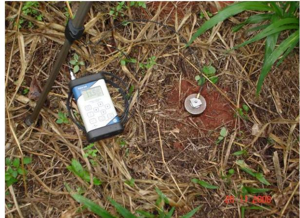
Figura A.1 – Local de medição com o microfone e o acelerômetro posicionados no ponto RVB-01
