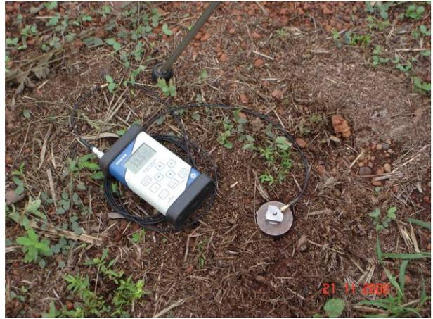
Figura A.10 – Local de medição com o microfone e o acelerômetro posicionados no ponto RVB-10
