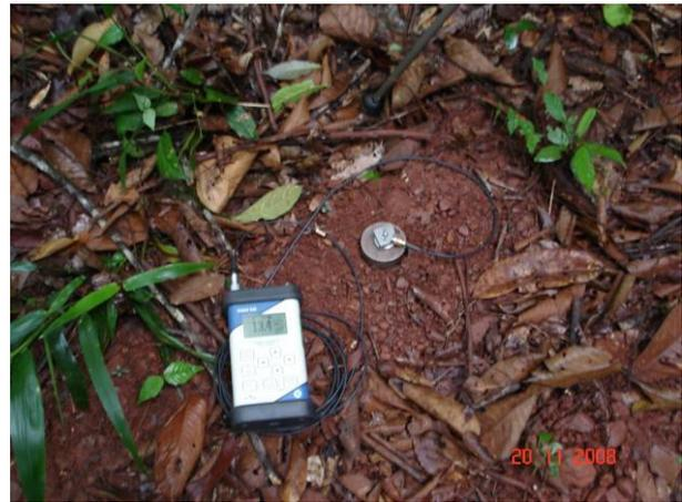
Figura A.4 – Local de medição com o microfone e o acelerômetro posicionados no ponto RVB-04
