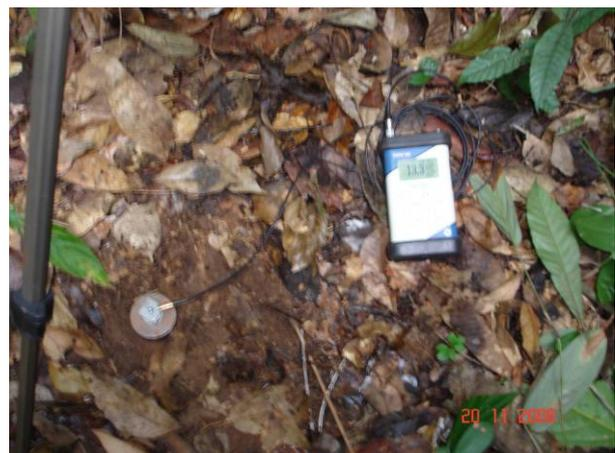
Figura A.6 – Local de medição com o microfone e o acelerômetro posicionados no ponto RVB-06
