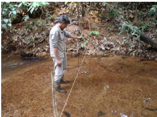
FOTO 13 – Medição de vazão no ribeirão Águas Claras na seção de réguas de monitoramento fluviométrico RA-05. (GOLDER, setembro de 2008).
