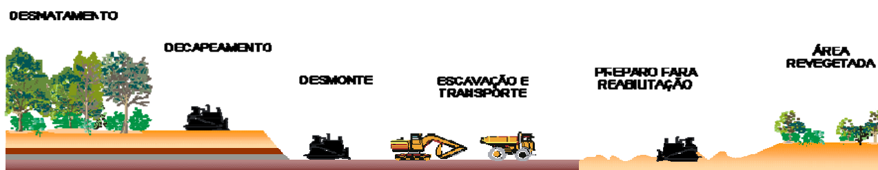
Figura 48: Método de lavra com reabilitação simultânea
