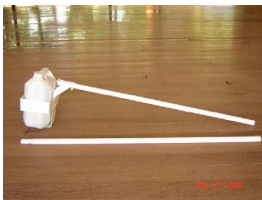
Figura 51: Equipamento de auxílio para realização das coletas de águas superficiais
