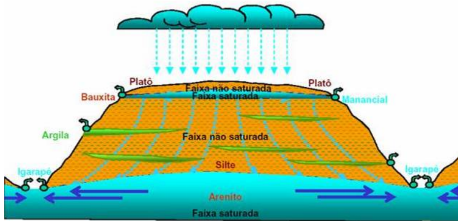
Figura 534: Comportamento esquemático vertical do fluxo subterrâneo.
