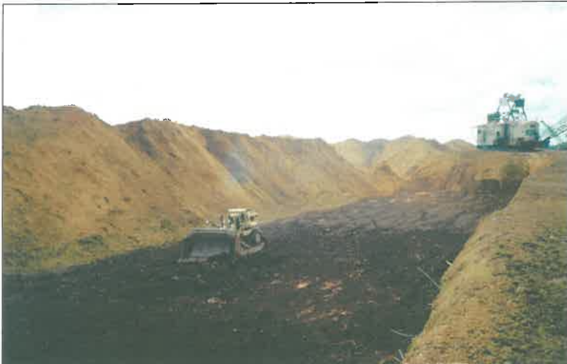
FOTO 2 - Piihas de estéril (material amarelo) e lavra de bauxita com trator D11N na Mina do Saracá.
