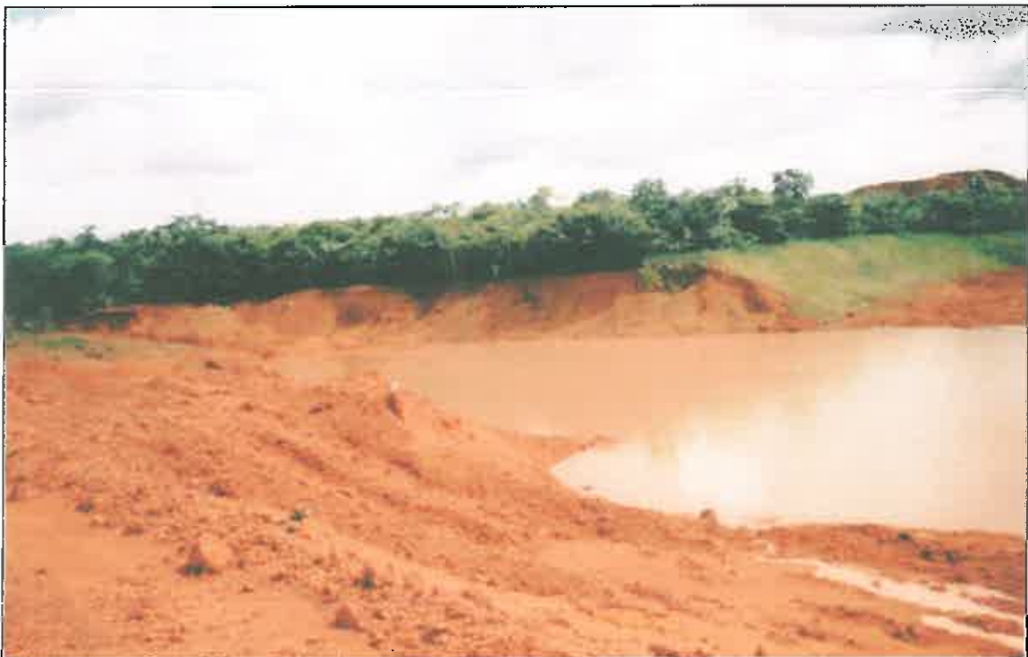
FOTO 15 - a acumulação em bacias de decantação internas à mina, designadas como "sumidouros".
