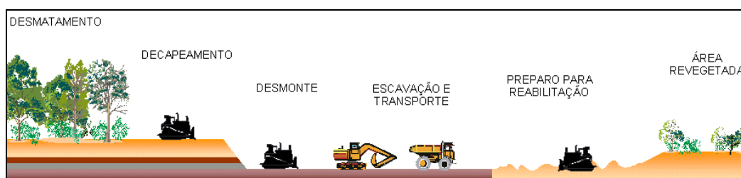
Figura 3.02 – Método de Lavra de Bauxita no Platô Monte Branco
