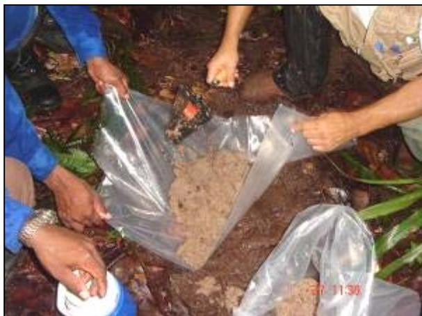
3 - As amostras foram homogeneizadas com o auxílio de uma colher de pedreiro e lona plástica.
