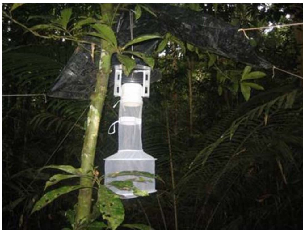
FOTO 72 - Armadilha de luz tipo HP utilizada para coletar mosquitos vetores.
