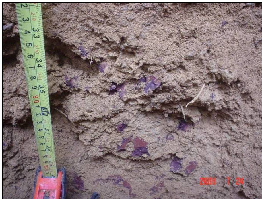
Foto 15 - Detalhe de petroplintita do Argissolo Amarelo Distrófico Abrúptico Petroplíntico, ponto P16 (coordenadas UTM 0548154; 9804546).
