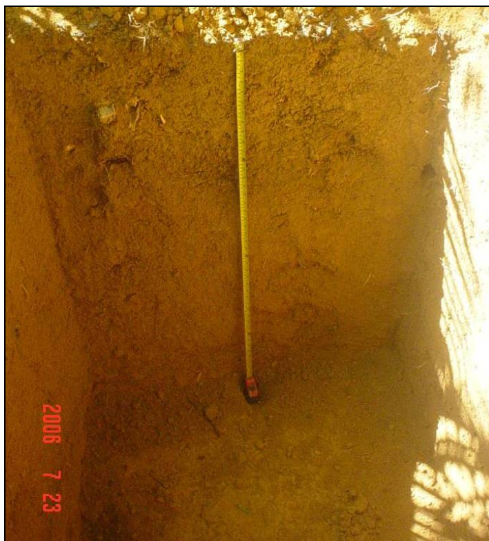
Foto 11 - Latossolo Amarelo Coeso Típico descrito em trincheira no Platô Bela Cruz. Ponto P10 (coordenadas 552534; 9802876).
