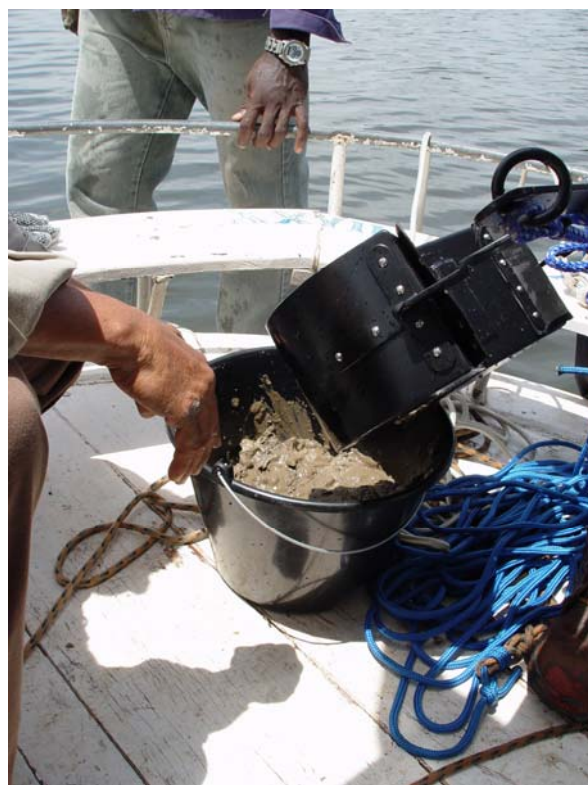
Fotografia 2. (A) Visão do amostrador de sedimentos tipo Van-Vin e (B) coleta de sedimentos do Rio Trombetas.
