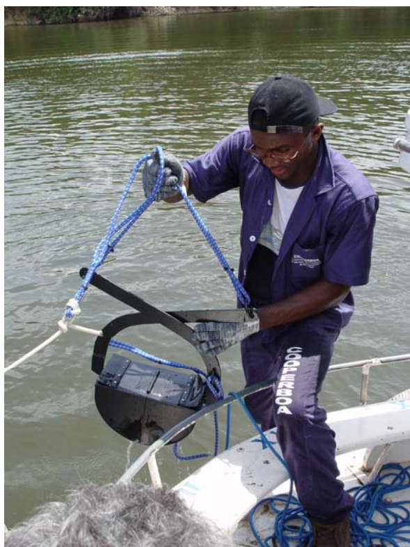
Fotografia 2. (A) Visão do amostrador de sedimentos tipo Van-Vin e (B) coleta de sedimentos do Rio Trombetas.
