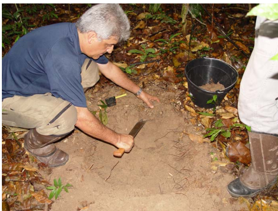
Fotografia 1. Detalhe da retirada de amostra deformada de camadas superficiais de solo para caracterização mineralógica.
