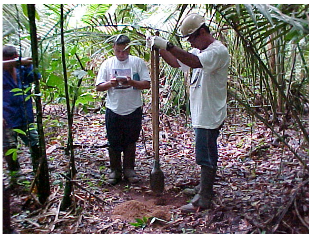
Fig. 2 e 3 – Técnicos realizando tradagens e identificação da cor do solo.
