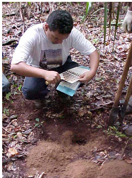
Fig. 2 e 3 – Técnicos realizando tradagens e identificação da cor do solo.
