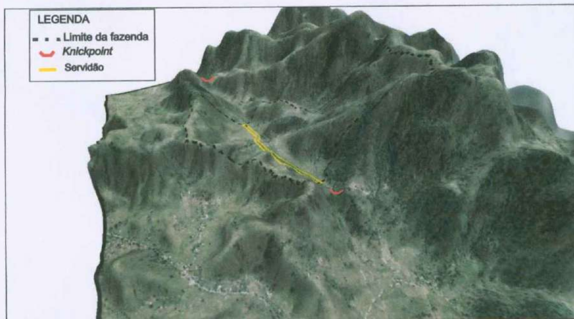
Figura 2 – Relevo esquemático da fazenda e entorno, com visada de leste para oeste, com destaque para a delimitação do vale suspenso nos locais de ruptura do relevo ( knickpoint ).
