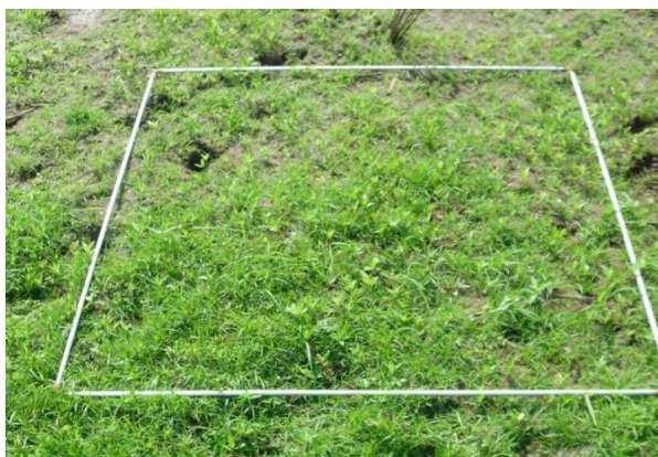
Figura 4.2.1.4.1-4. Quadro de metal com 1x1m utilizado para estudos quantitativos de herbáceas.
