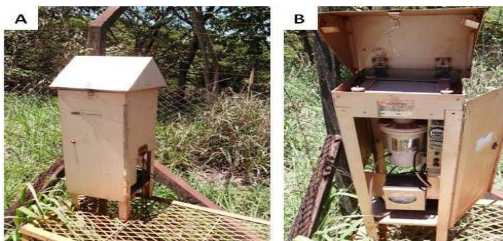
Figura 4.1.2.2-1. Exemplos dos amostradores de Grande Volume (AGV/PTS) da rede de monitoramento da VALE-MCR.
