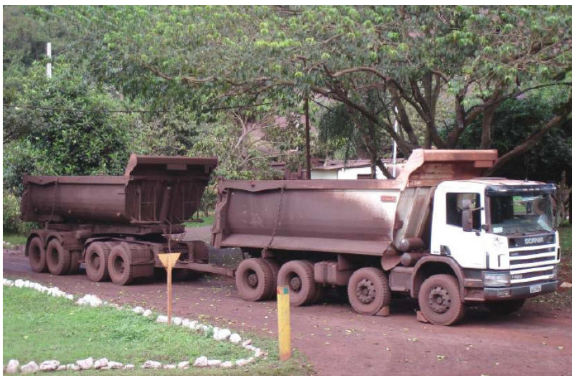
Figura 2.2.5-2: Caminhão 8x4 acoplado a reboque – carga líquida de 70t.
