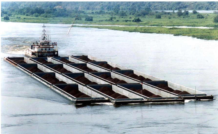
Figura 2.2.5-8: Comboio típico de transporte de minério de ferro utilizado pela MCR para transporte dos seus produtos. Empurrador e 16 barcaças.
