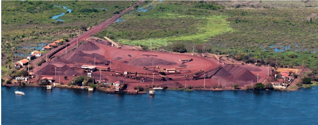
Figura 2.2.5-7: Vista aérea do Porto Gregório Curvo (Corumbá) de propriedade da MCR. Típico porto fluvial para embarque de minério de ferro em barcaças.
