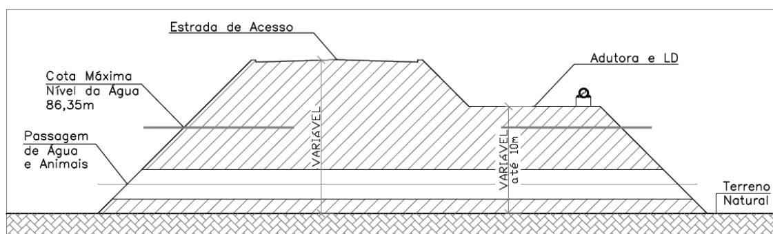
Figura 2.2.2.6.1-4: Corte Tipo do aterro
