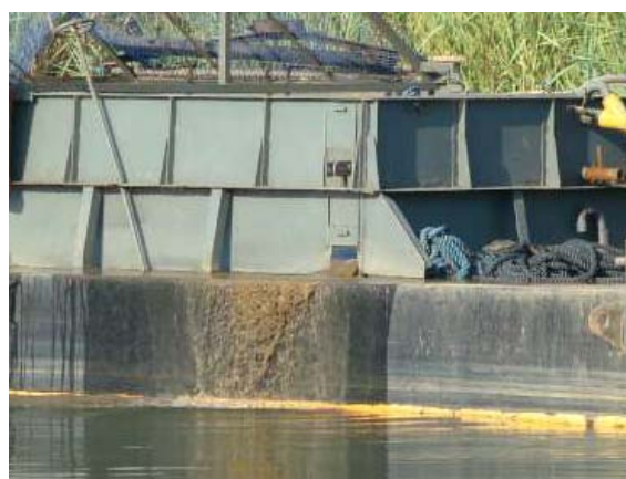
Figura 4.4-7: Dragas Siluma – Drenos para vazão do excesso de água ( overflow ).
