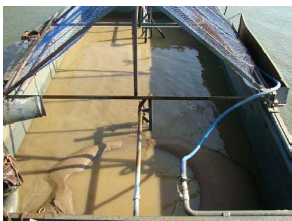
Figura 4.4-6: Dragas Siluma – Vista da cisterna carregada com areia.
