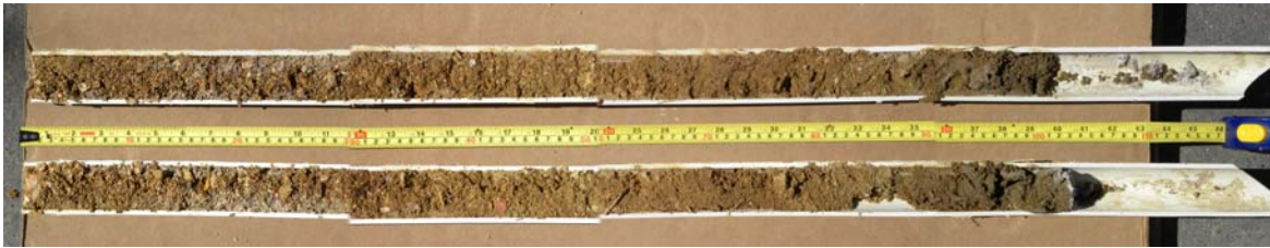
Figura 4.4-25: Exemplo de testemunho coletado para a determinação da espessura do pacote sedimentar nas áreas de pesquisa da Algadermis.
