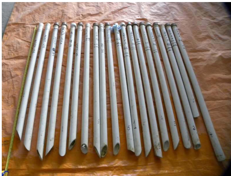
Figura 4.4-24: Testemunhos coletados para a determinação da espessura do pacote sedimentar nas áreas de pesquisa da Algadermis.
