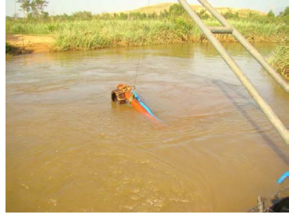
Figura 4.4-14: Extremidade da tubulação de dragagem.
