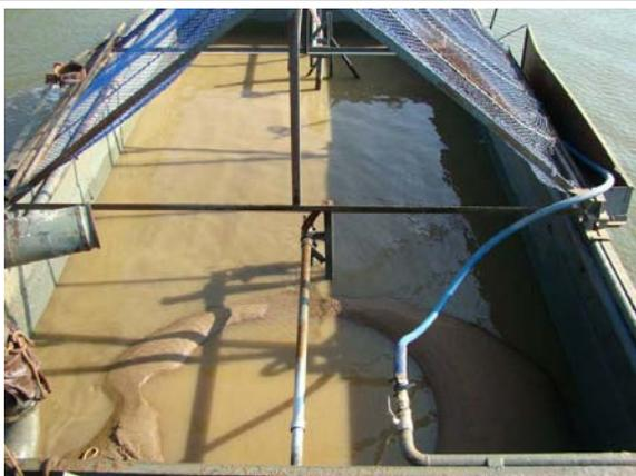
Figura 6: Draga Siluma – Vista da cisterna carregada com areia.
