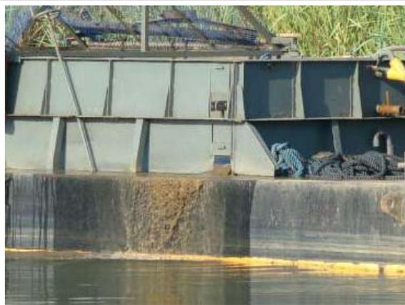
Figura 7: Draga Siluma – Drenos para vazão do excesso de água (*overflow*).
