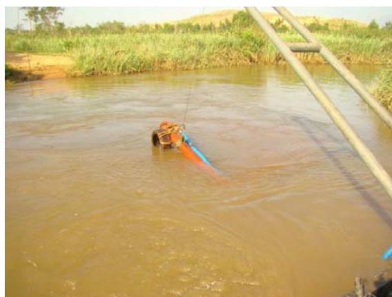
Figura 13: Braço e guincho para sustentação da tubulação de dragagem. Figura 14: Extremidade da tubulação de dragagem.
