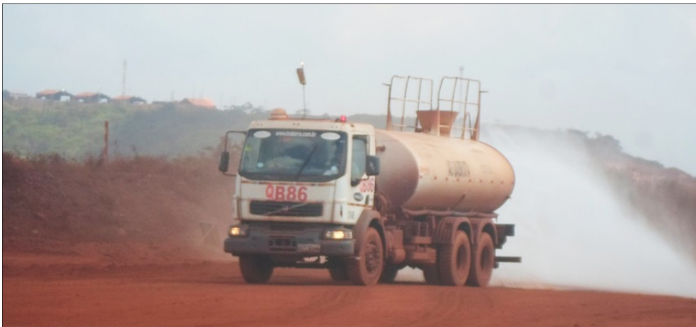
Foto 14.2.13.6- Kit de combate a incêndios (caminhão pipa) disponibilizado às contratadas.
