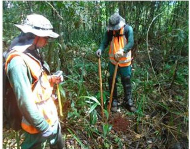
Foto 189: Execução de sondagem em solo siltoso
