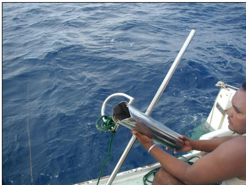
Figura 31. Imagem draga para coleta de amostras do sedimento
