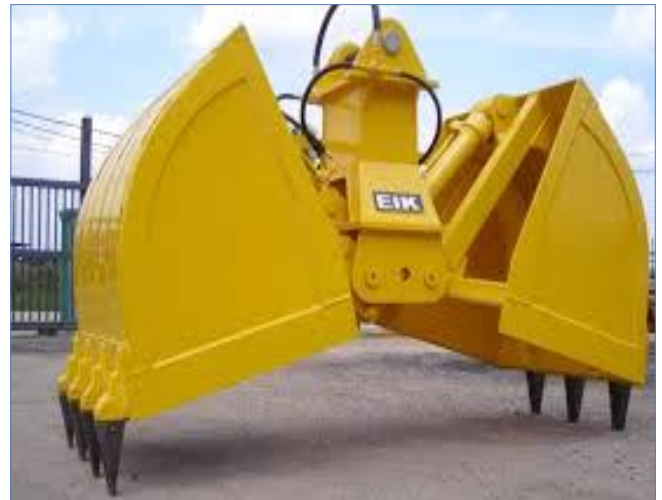
Figura 10. Modelo de equipamento utilizado para descarregamento do material dragado.
