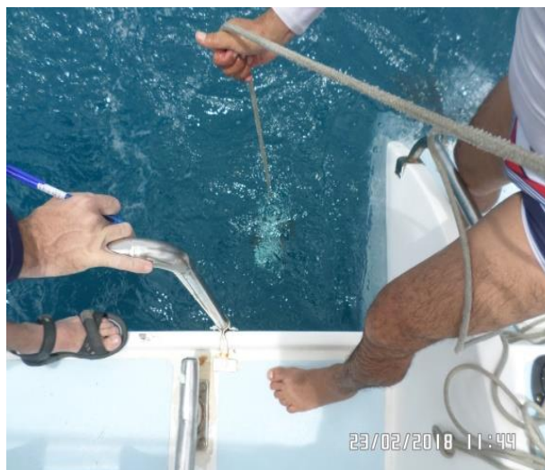
Figura 33. Determinação em campo de transparência.
