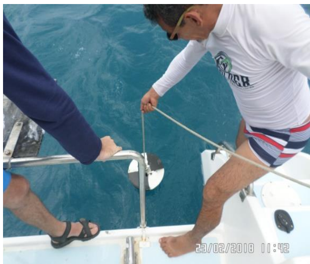
Figura 33. Determinação em campo de transparência.
