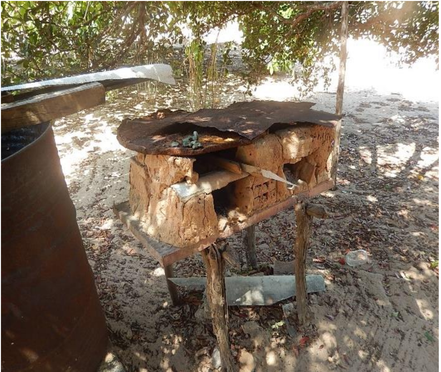
Figura 5.3.12.3-7: Forno artesanal para torrar castanha de caju. Fonte: DPG Consultoria, 2018.
